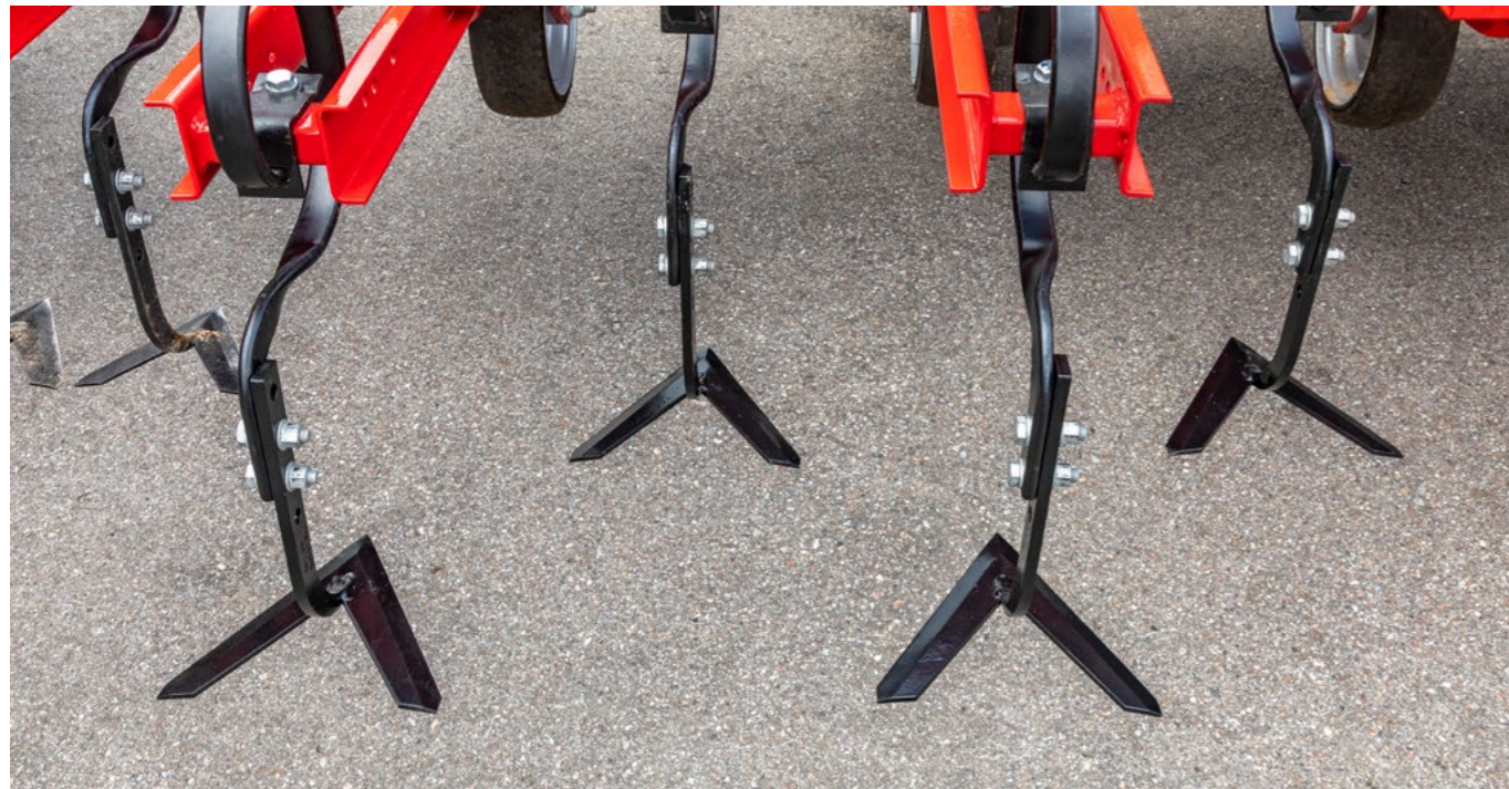
Equipamiento de paralelogramo para un espacio entre hileras de 25 cm
