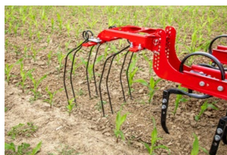
La rastra de arrastre elimina la tierra de las malas hierbas cortadas
