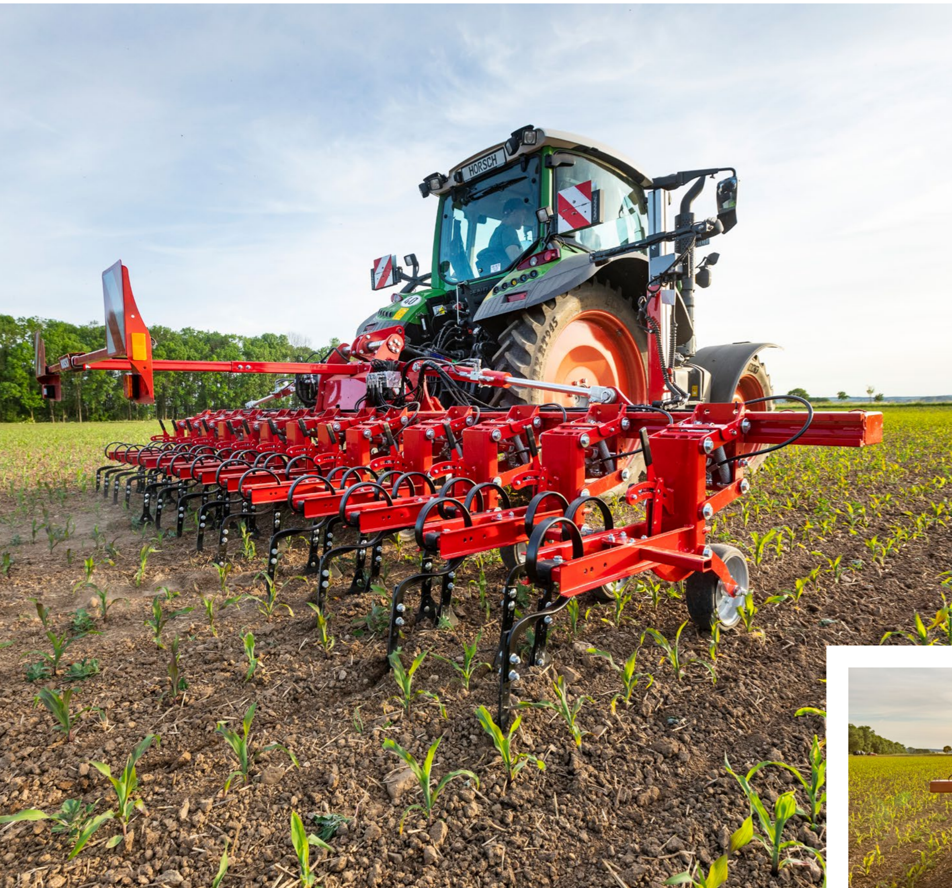
Control de alta precisión a lo largo de la hilera de plantas mediante la cámara opcional Culticam
