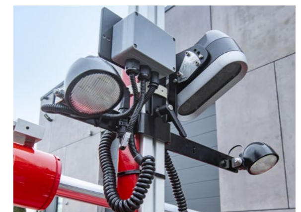
Control de cámara Culticam con paquete de luz opcional para trabajos al amanecer o en la oscuridad
