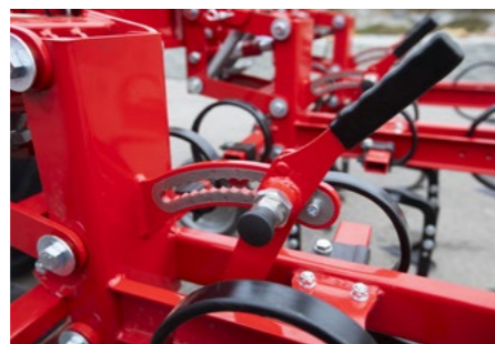
Paralelogramo de amplia base con ajuste central de profundidad
