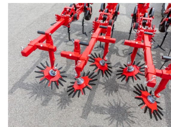
La escarda de dedos permite un trabajo preciso en o entre las filas de plantas, por ejemplo, en el maíz
