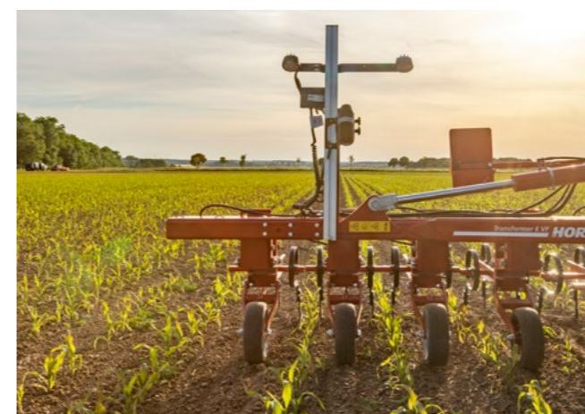
Control de alta precisión a lo largo de la hilera de plantas mediante la cámara opcional Culticam
