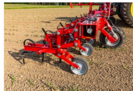
Robusto marco cuadrado con sujeción interna
