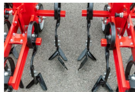
Placas de cresta en la variante „izquierda/derecha”
