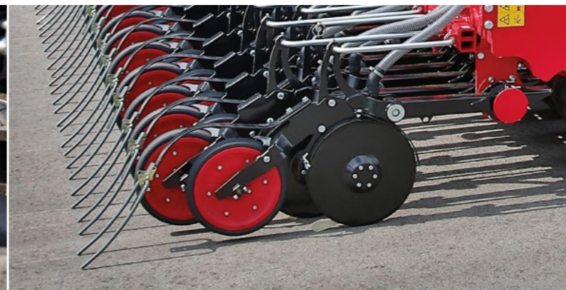
Reja de siembra PowerDisc con una presión de reja de hasta 150 kg
