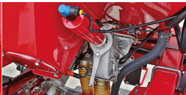
Compuesto microgranulado con dosificador de tornillo sinfín
