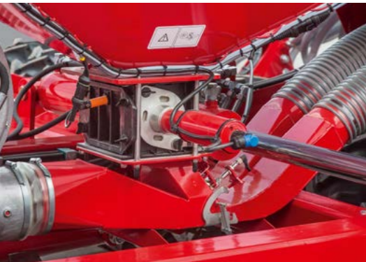
Dosificador compacto Dosificación precisa con accionamiento eléctrico
