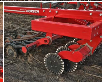
Las rejas onduladas cultivan la tierra eficientemente y son de tracción suave.
