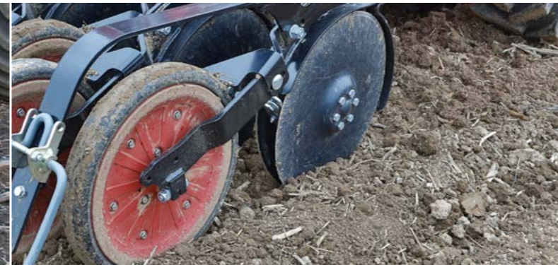
Reja de doble disco Discos rectos con rodamientos internos libres de mantenimiento
