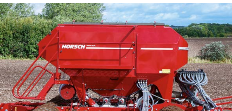
Depósito doble de gran volumen Hasta 5 000 l de capacidad del depósito, distribución 40:60
