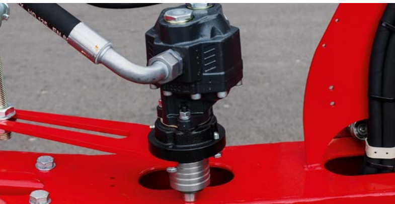
Ventilador hidráulico con accionamiento del árbol cardán
