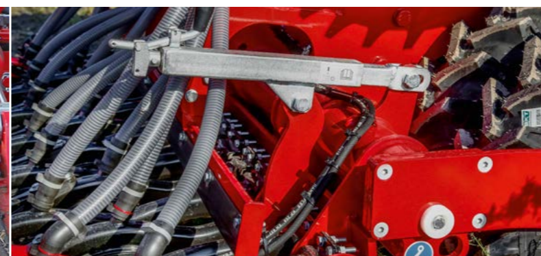
Enganche amortiguado contra oscilaciones Adaptación óptima al suelo y seguridad contra piedras
