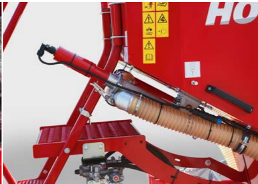
Dispositivo de dosificación de microgranulado (tolva individual)
