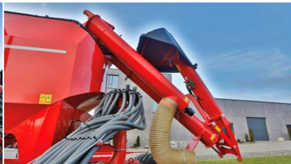
Plegable hidráulicamente en posición de transporte
