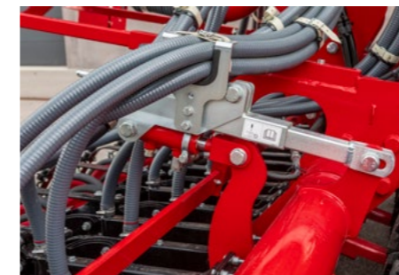
La presión de la reja puede aumentarse a través del dispositivo de control del tractor
