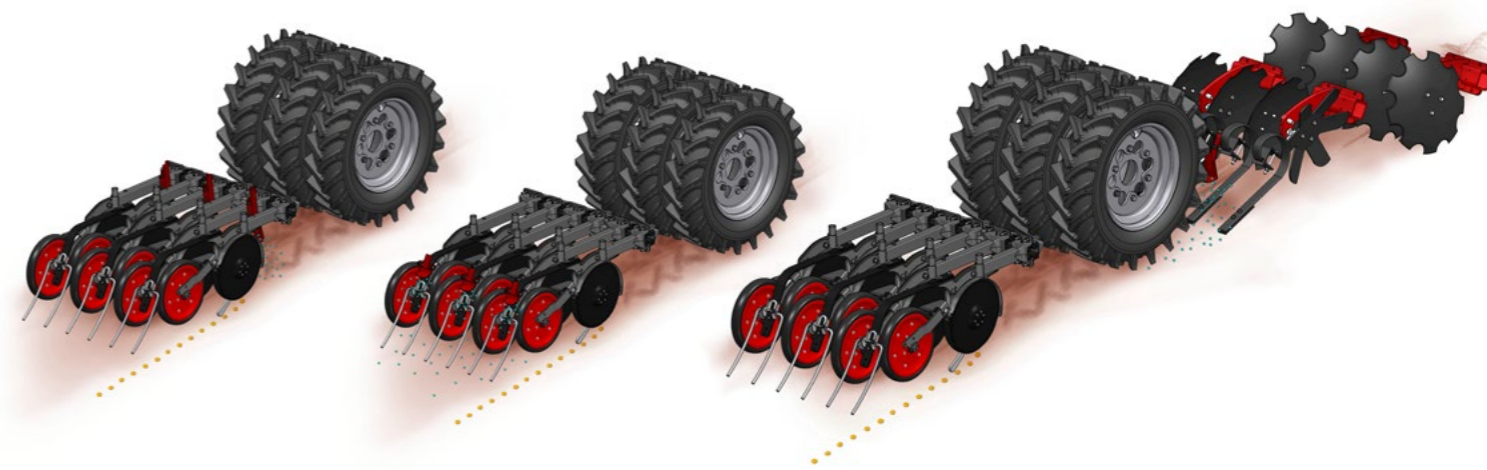
MiniDrill opción 9: aplicación a través del plato deflector en el Crossbar. Ideal para la aplicación de semilla fina al ser consolidadas de nuevo por el compactador de neumáticos.
