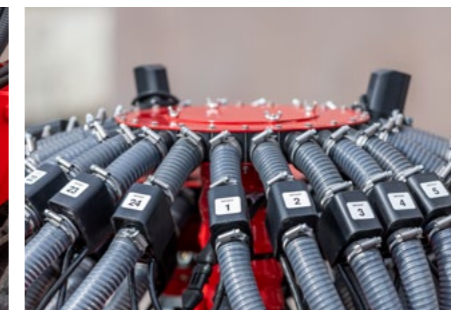
Neumática mejorada para semillas con cáscara
