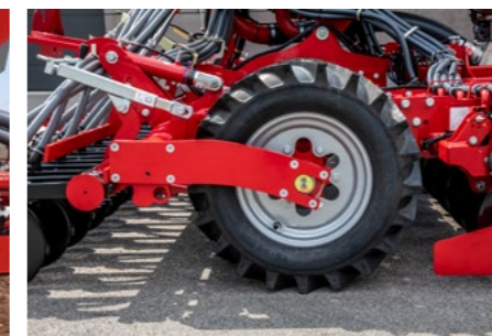
Baja demanda de potencia gracias al gran diámetro de los neumáticos y a que no se necesitan raspadores.
