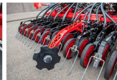
La intensidad del marcador de pre-emergencia se ajusta mediante un tope de profundidad.
