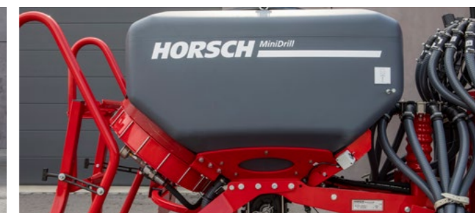
Las versiones MiniDrill Solo están equipadas con un ventilador propio, un sistema neumático propio y otro umbral de colocación
