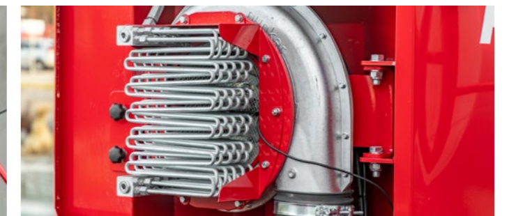
Reduce la temperatura del aceite en el sistema y alivia el enfriador de aceite del tractor
