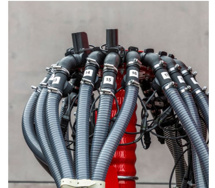
Control de flujo de fertilizantes y semillas – para una supervisión continua de las mangueras de siembra y fertilización
