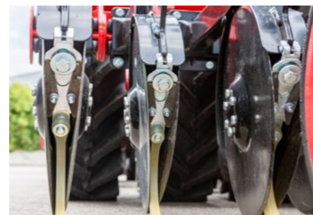
El raspador móvil garantiza un alto efecto de autolimpieza en condiciones húmedas
