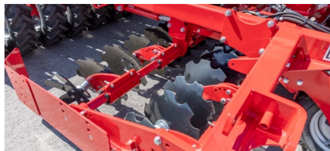
DiscSystem con discos descompactadores ajustables
