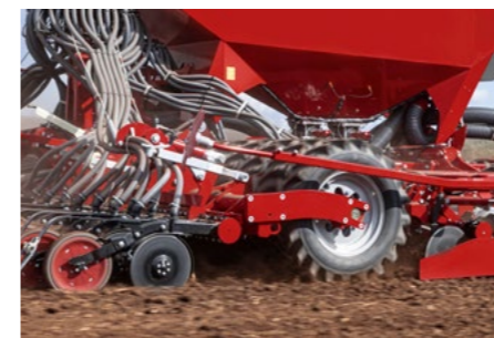
Consolidación eficaz por debajo del umbral de siembra para una mejor distribución del agua hacia las semillas.
