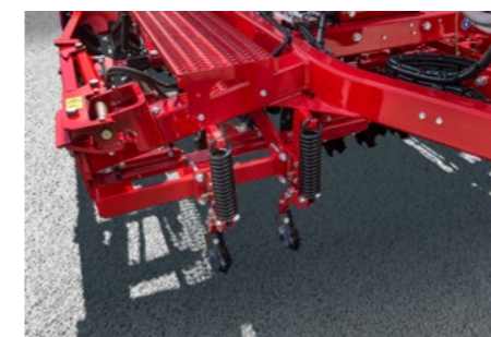
Las púas borra-huellas con suspensión de muelles aflojan las compactaciones del suelo en las vías del tractor
