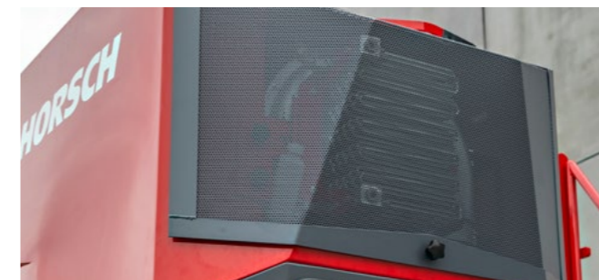
Refrigeración por aceite del ventilador hidráulico: calienta el flujo de aire del sistema neumático
