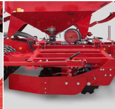
Chapas laterales móviles Para evitar obstrucciones en la zona de conexión
