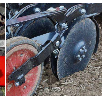
Reja de siembra de doble disco Discos rectos con cojinete interior que no requiere mantenimiento
