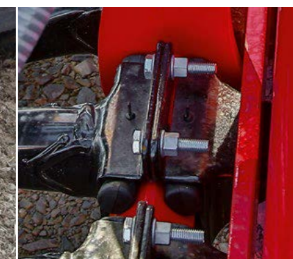
Enganche amortiguado contra oscilaciones Adaptación óptima al suelo y seguridad contra piedras
