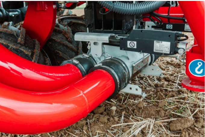
Desconexión eléctrica de media sección: encendido y apagado sencillo de la media sección mediante un botón en el terminal.
