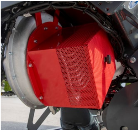
Enfriador de aceite opcional para calentar el aire aspirado
