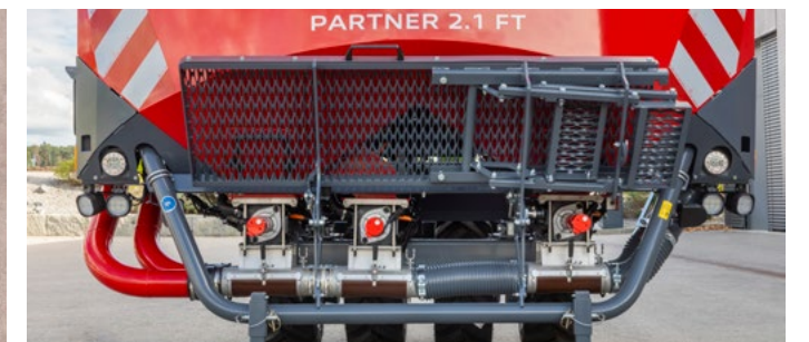
Partner 2.1 & 2.5 FT con Tripletank: 3 dispositivos dosificadores independientes para hasta 3 componentes
