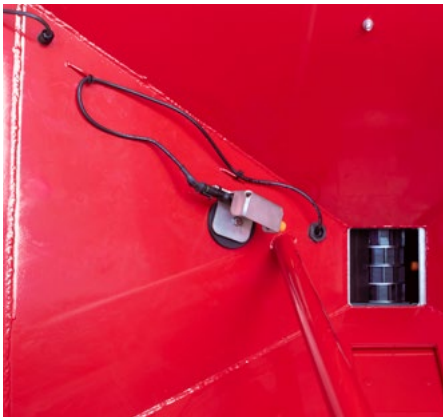
2 sensores de nivel: uno ajustable en altura dentro del tanque y otro directamente en el dosificador.
