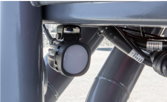
Iluminación de la unidad dosificadora para un ajuste cómodo
