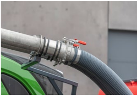
Los acoplamientos rápidos facilitan el acoplamiento y desacoplamiento rápido entre el tanque frontal, la consola del tractor y el implemento agrícola.
