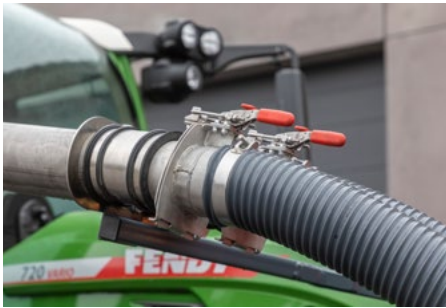
Manejo sencillo y sin herramientas de la tubería neumática.
