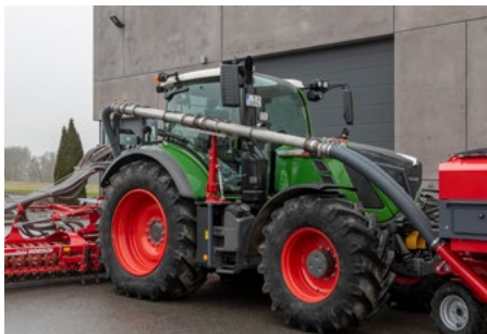
La instalación de tuberías horizontales garantiza una mínima obstrucción de la visibilidad.
