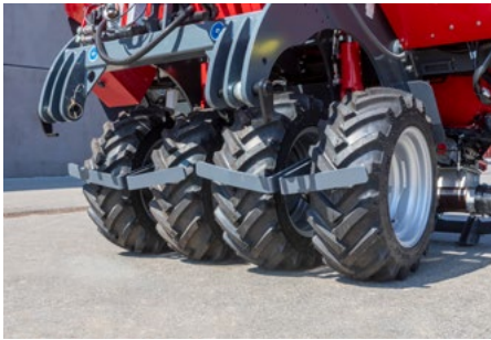
Compactador intermedio de dirección pasiva con elevación hidráulica
