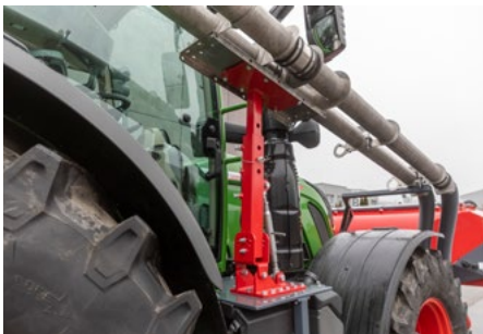
Brazo de montaje estable y seguro para componentes neumáticos del Partner FT
