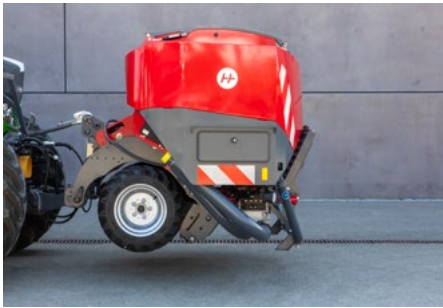
Rodillo intermedio con elevación hidráulica en posición de transporte por carretera
