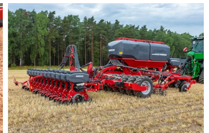
Siembra StripTill con el Maestro RV combinado con el Focus TD con enganche de 3 puntos
