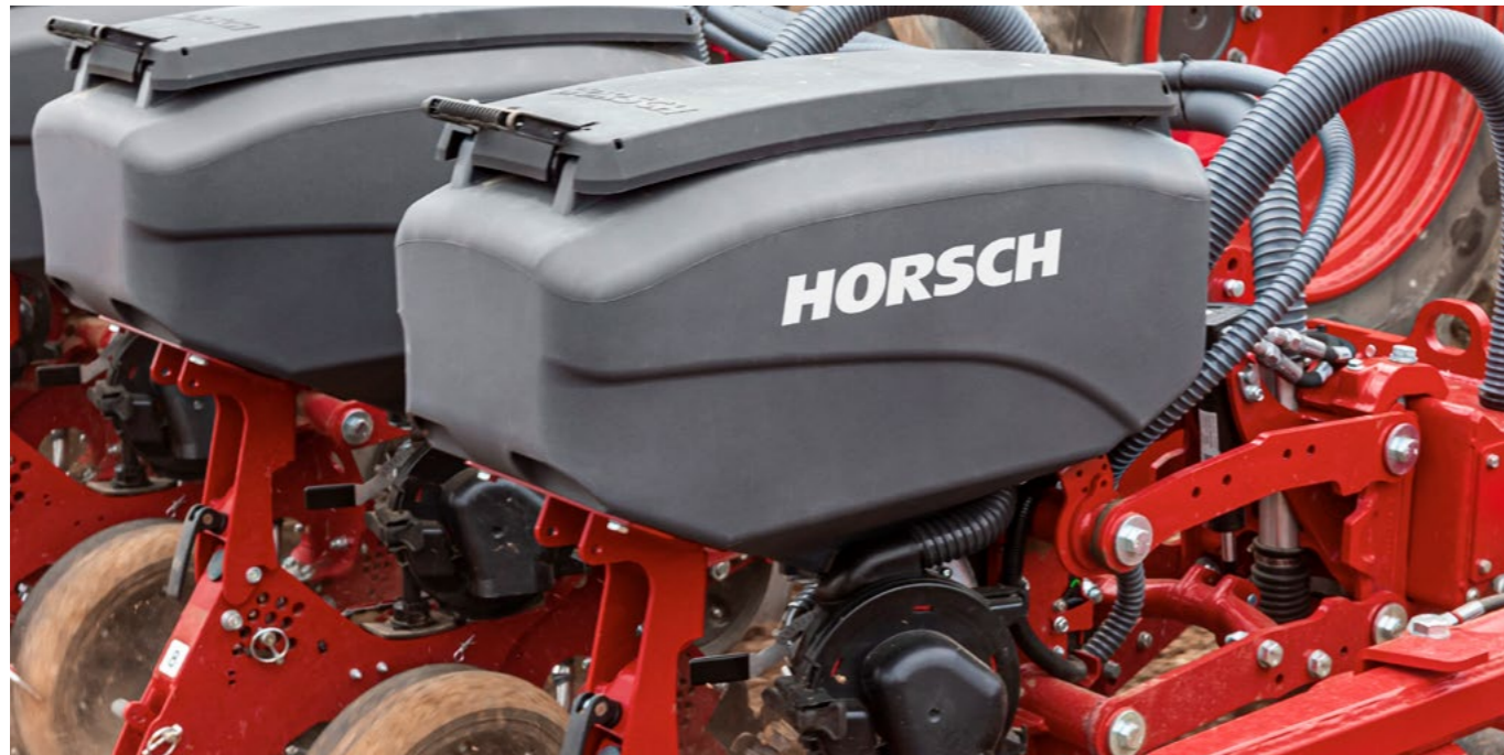
Tanque de hileras con un volumen de 70 l
