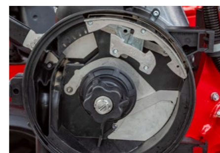
El singulador universal no necesita ser ajustado
