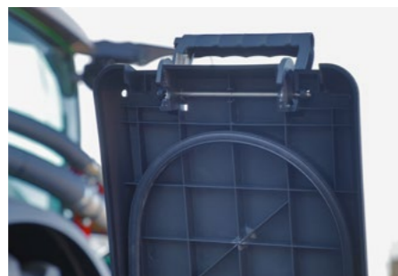
Junta de la tapa del depósito de hileras
