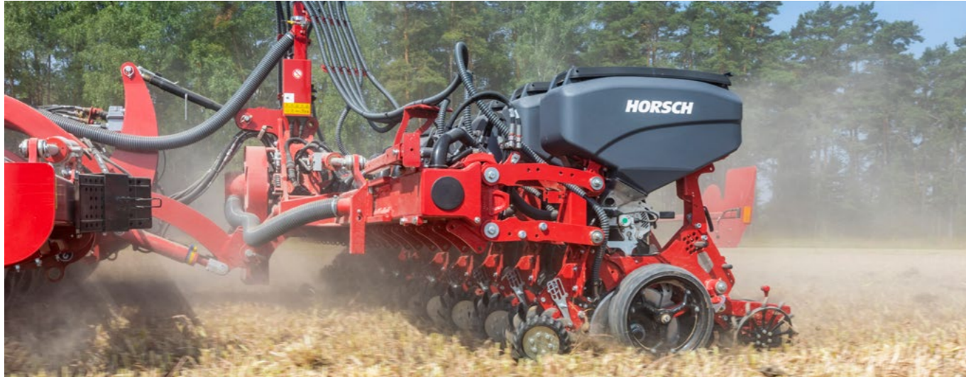
Con el equipo de vagón de siembra, se dispone hasta 350 kg de presión de reja
