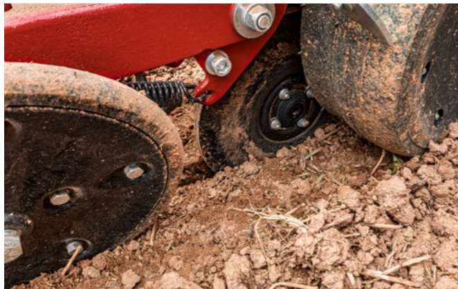
El rodillo receptor es crucial para un buen contacto entre el grano y el suelo
