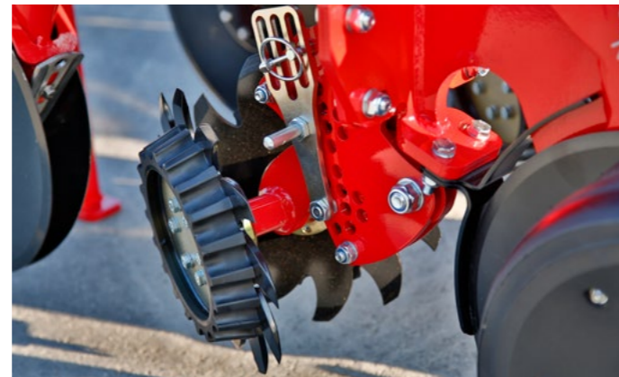
Estrellas desbrozadoras opcionales, flotantes con control de profundidad
