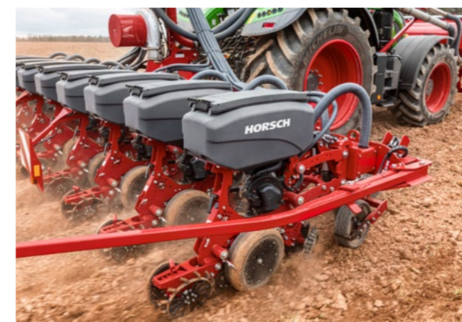
Ajuste hidráulico de presión de reja para una colocación perfecta
