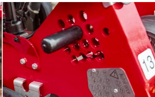
Patrón de agujeros para ajuste de profundidad en 14 etapas
