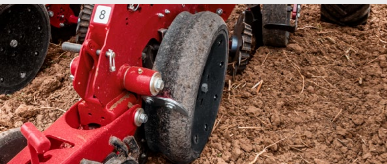
Sensor de presión AutoForce: Se realiza el control del peso a través de la tecnología Piezo (sensor de presión).
