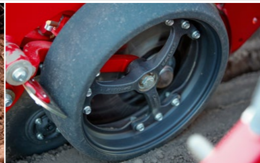
Rueda de control de profundidad con radios
