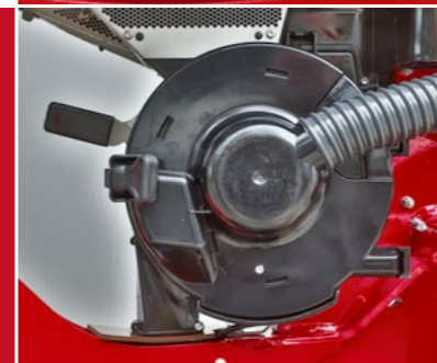
Dosificador de fácil acceso con diferentes discos dosificadores según el tipo de cultivo
