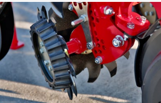
Ruedas limpiastrojos opcionales, flotantes con control de profundidad
