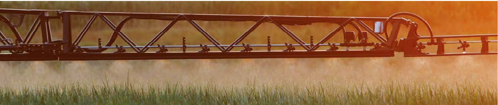
BoomControl – control automático de la altura mediante sensores de ultrasonidos
