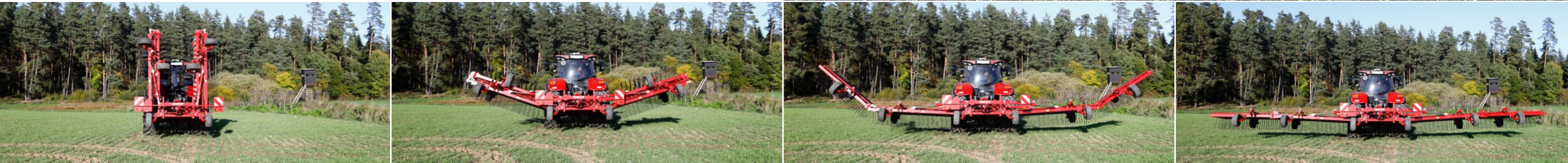
Doblado gracias a los dobles cilindros de elevación para un plegado de 90°.
