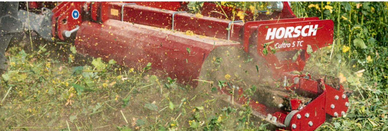
Rodillo de cuchillas dobles para un magnífico rendimiento de trituración
