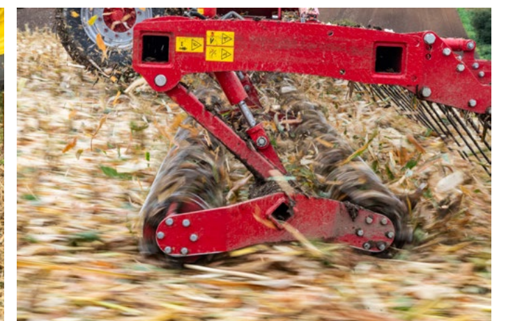
Rodillo de cuchillas dobles con una longitud de corte teórica de 14 cm.
