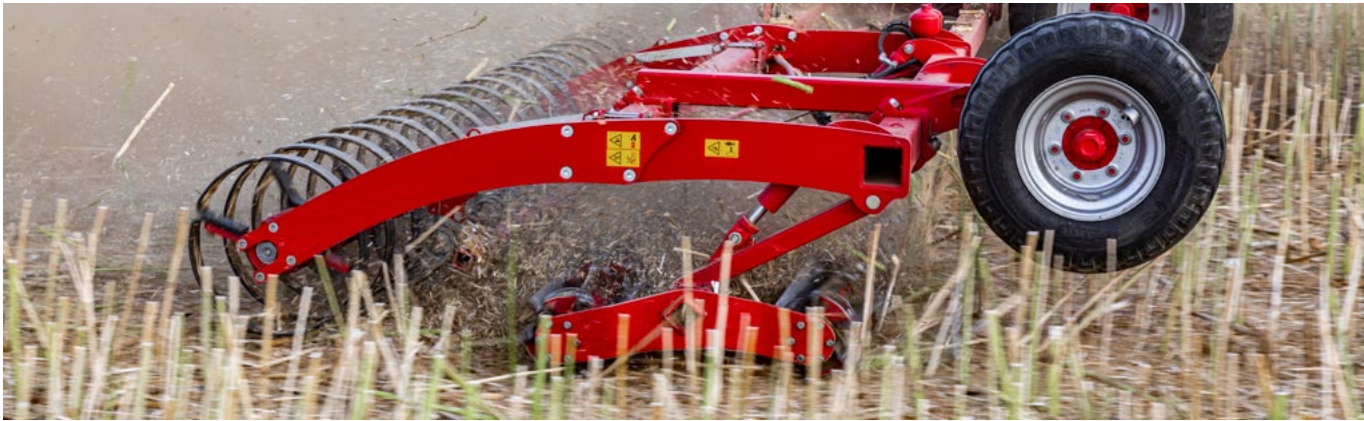
Opcional con rodillo compactador para una compactación uniforme
