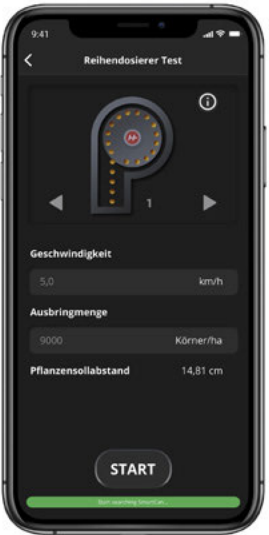
С помощью приложения HORSCH Control можно в любое время протестировать основные параметры качества сева с разбивкой по отдельным рядам
