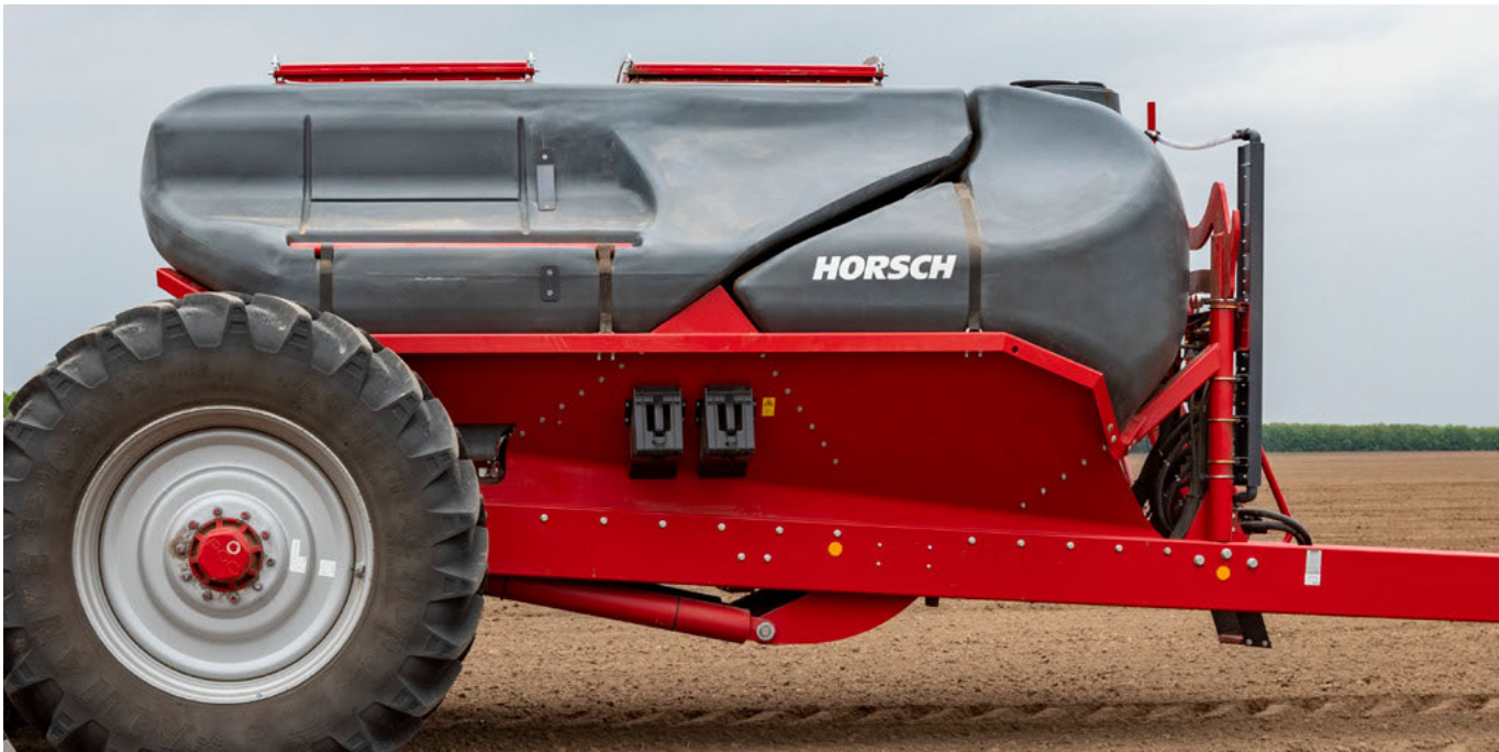
Система внесения жидких удобрений с баком, насосом, контролем расхода по рядам и отключением рядов по секциям
