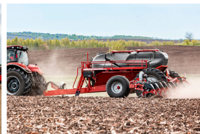
Перераспределение веса бункера на высевающую секцию для увеличения давления до 350 кг на сошник
