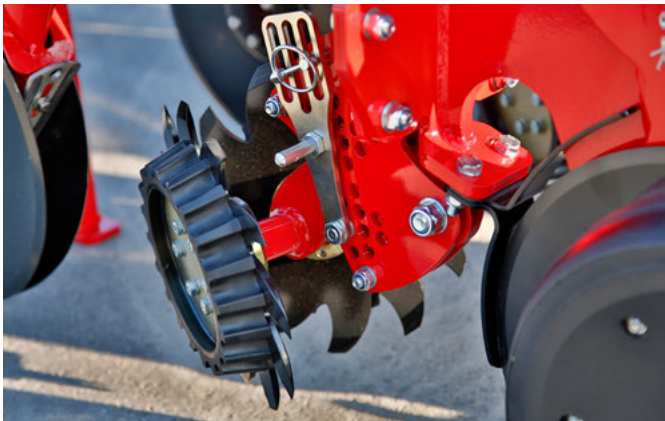
Опциональные бороздоочистители с регулировкой глубины в плавающем положении
