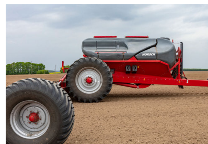
Бак для жидких удобрений объемом 3 900 л, бункер для семян объемом 5 000 л
