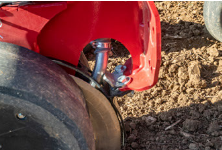
Внесение в борозду при помощи пневматики
