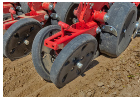
Широкие прикатывающие ролики с V-образным расположением
