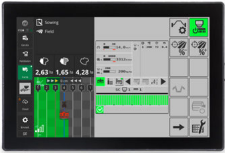
Отображение до трех виджетов рядом с основным рабочим экраном позволяет одновременно следить за работой нескольких приложений
