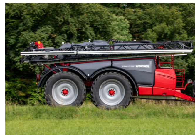
Плавное движение по дороге благодаря тандемному шасси и гидравлической подвеске
