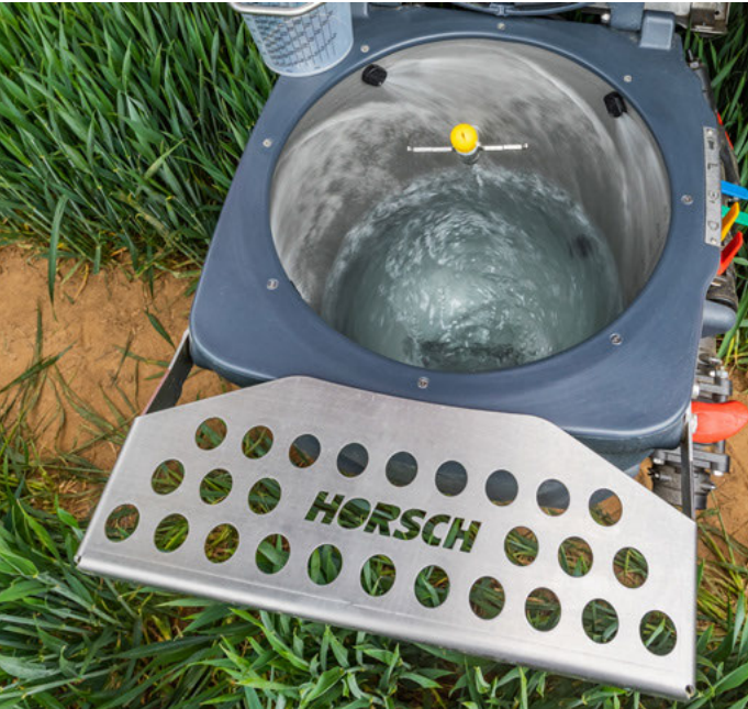
Заправочная станция из нержавеющей стали объемом 52 л с дополнительной ударной форсункой
