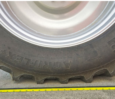
ATP Control: легкий ход с давлением в шинах 2,3 бар
