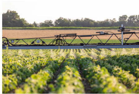
Эффективное ленточное распыление непосредственно над рядом растений с системой управления на базе камеры (опция)
