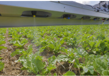
Ленточное опрыскивание также не представляет проблем при расстоянии между форсунками в 25 см
