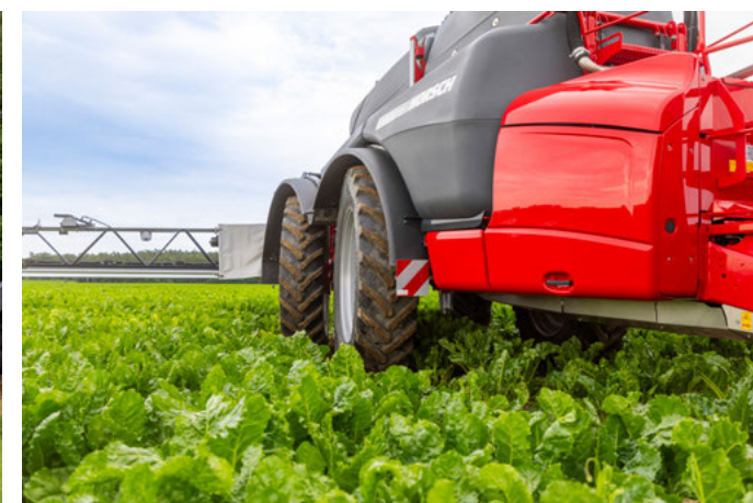
Возможность активного управления колесами обеих осей интегрирована в ПО агрегата
