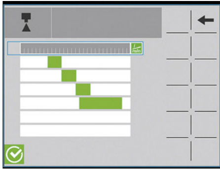
Зоны перекрытия форсунок в интерфейсе AutoSelect
