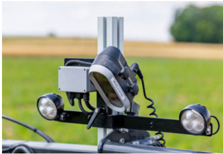
Система управления на базе камеры CultiCam с освещением для работы в сумерках и ночью
