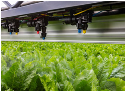
Пневматическое переключение форсунок в комбинации 2-2 с 3D-распылением
