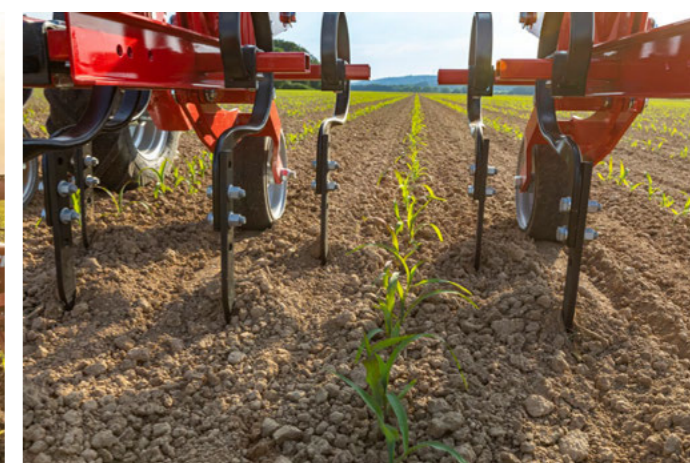
Megbízható és precíz kapálás a növény sor mentén különböző fejlettségi stádiumokban
