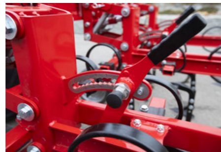
Széles csapágyazása paralelogramma központi mélységállítással
