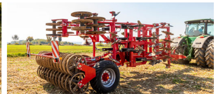
Szállítási helyzet aláforduló futóművel
