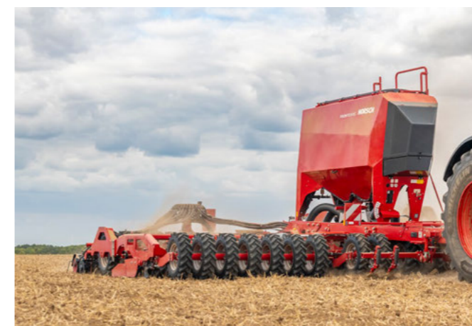
Nyomlazító kapák, hogy a traktor nyomát újra fellazítsák
