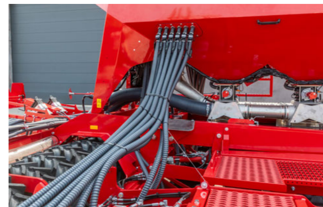
PPF Duplatartály Pronto 9 DC elosztótorny a tartályban
