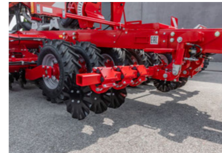
Nyomlazító tárcsák lazítják a talajtömörödést a traktor nyomában
