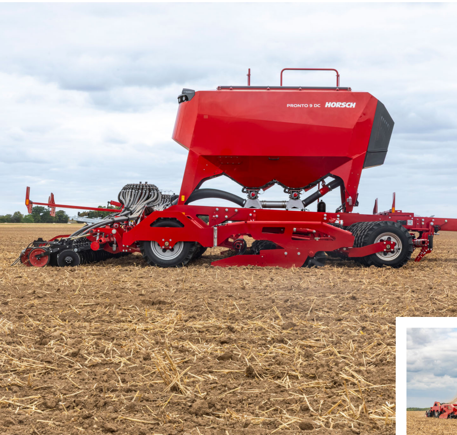
Nyomlazító kapák, hogy a traktor nyomát újra fellazítsák
