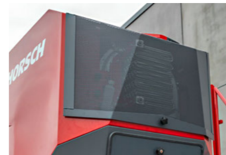
Olajhűtés a hidraulikus ventilátoron – felmelegíti a légáramot a pneumatikus rendszerben
