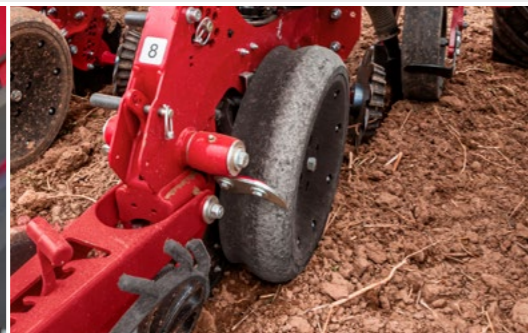
A RID kerék csökkenti a talajtömörödést közvetlenül a vetőnyílásnál nagyon kötött talajoknál vagy direktvetés esetén.
