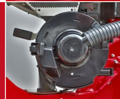
Könnyen hozzáférhető adagolórendszer különböző adagolótárcsákkal, a terménytípusnak megfelelően
