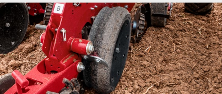
AutoForce nyomásszenzor: A súly mérése Piezo technikával történik
