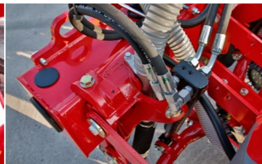
Szorítóprofilos rögzítés a 12 sorról 8 sorra történő egyszerű átszereléshez, valamint hidraulika henger a csoroszlyanyomás előállításához, alapfelszereltségként.
