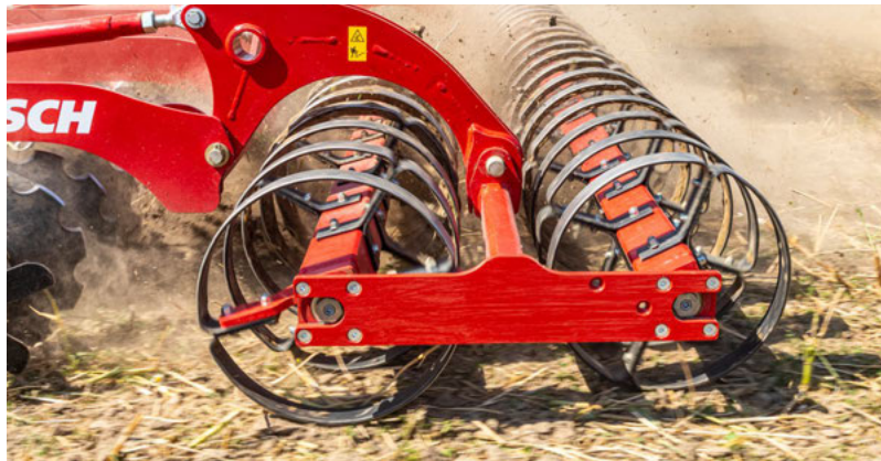
Inga felfüggesztésű dupla hengerváz az optimális kontúrkövetéshez
