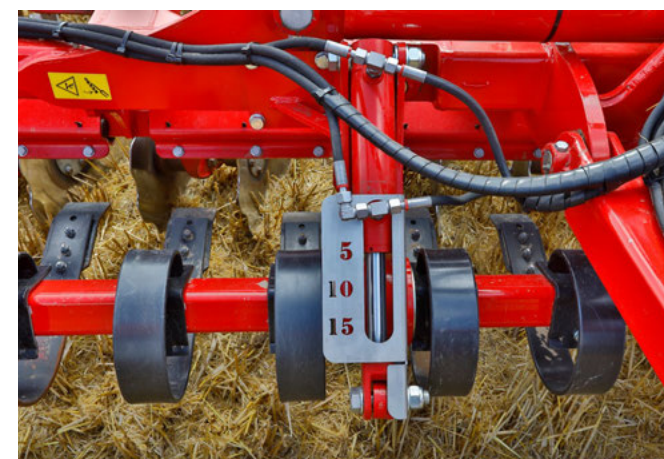
Crossbar mint kiegészítő egyengető eszköz
