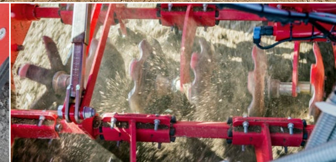
DiscSystem tárcsarendszer a intenzív talajműveléshez. Még a nagymennyiségű szármagadványra sem érzékeny.
