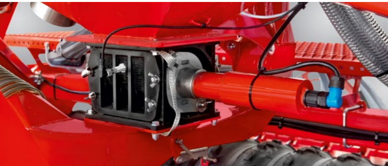
Adagolóegység – elektronikus meghajtás a vetőmag adagolásához. Gyors, egyszerű és pontos leforgatást tesz lehetővé.
