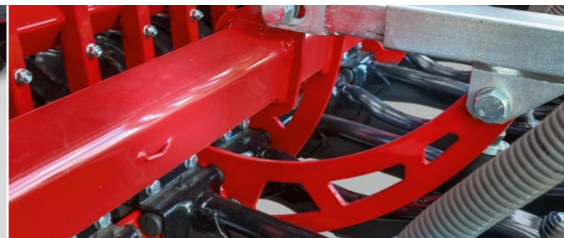
Fokozatmentes csoroslyanyomás-állítás A kézi beállítás megnöveli a gumielemelek előfeszítését
