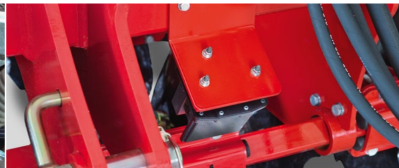
Radarszenzor a sebesség pontos meghatározásához és a vetőmag mennyiségének szabályozásához
