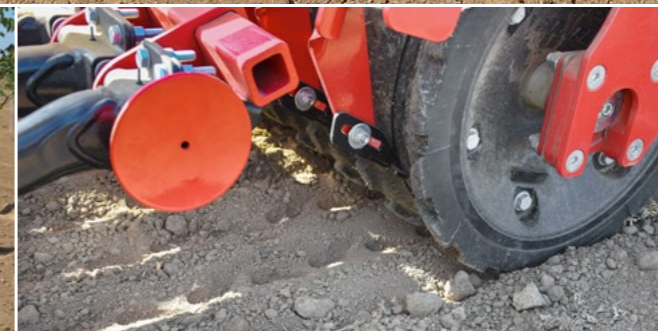
Az 54 centiméter átmérőjű FarmFlex henger a sávos visszatömörítésért. Minden talajtípushoz alkalmas.
