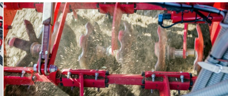
2-soros DiscSystem tárcsarendszer – jelentősen alacsonyabb üzemanyagigény az aktív frontfüggesztésű eszközökhöz képest (pl. forgóborona). Kitűnő magágy-előkészítés nagy munkasebességnél.
