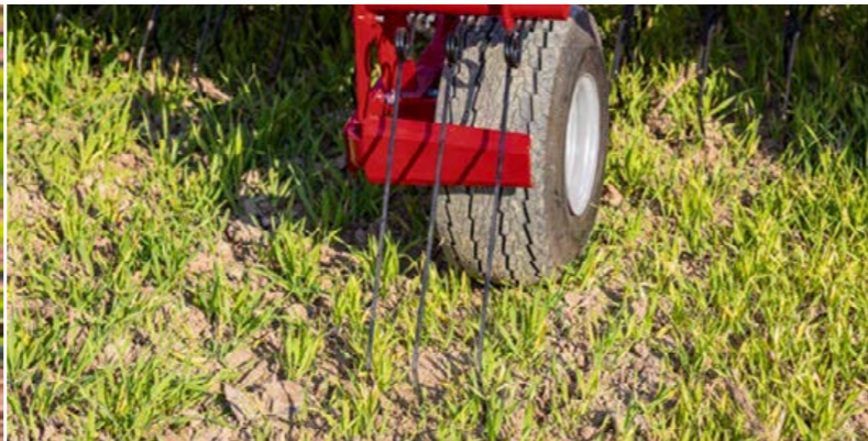
60 mm hosszú, keményfém kopóréteggel ellátott fogak
