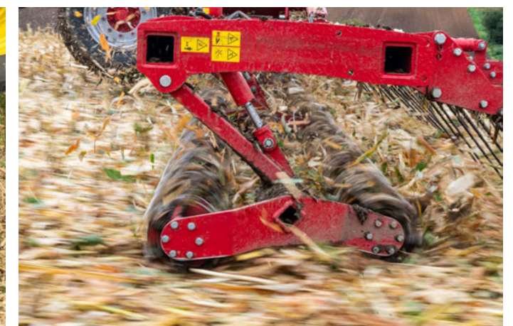
Dupla késhenger 14 cm elméleti aprítási hosszúsággal
