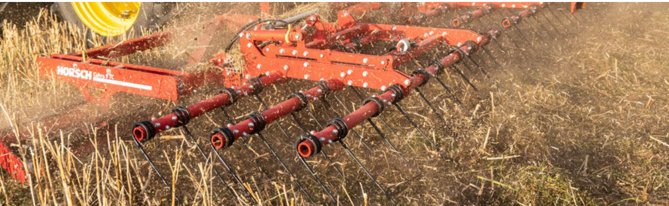
Opcionális 3 soros nehézgereblyével az aprómorzsza előállításához és a szerves anyag elosztatásához
