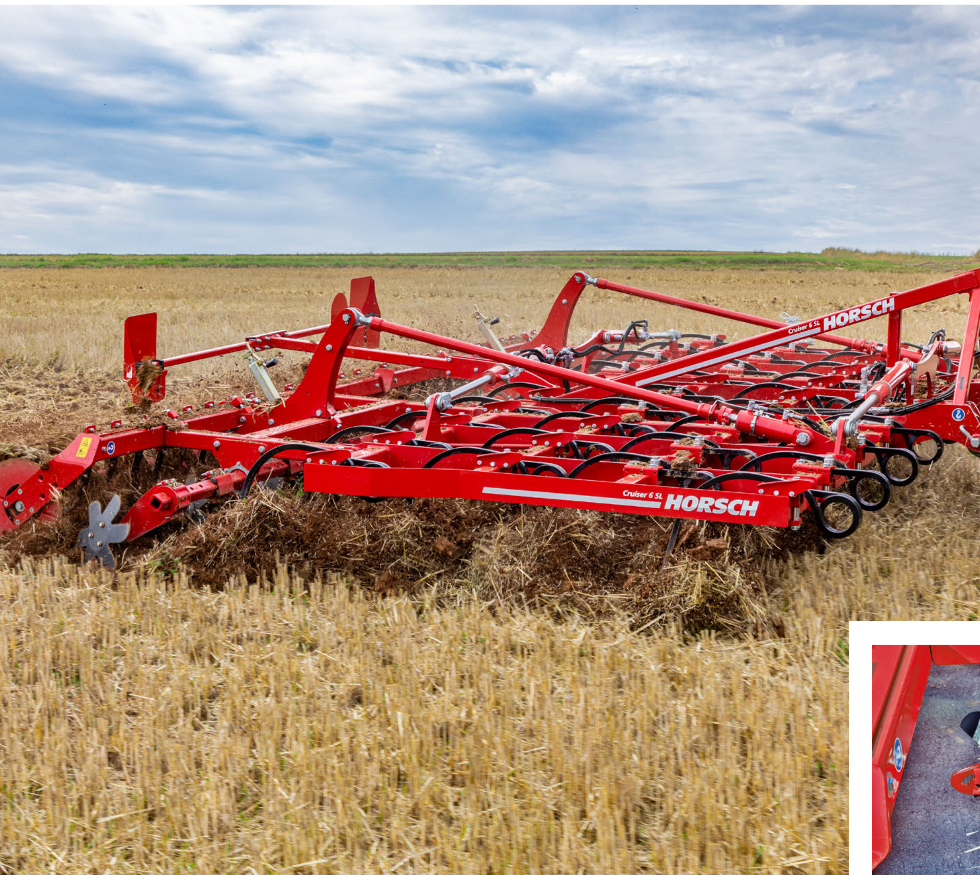
Gumi csapágyazású egyengetőtárcsák a túlterhelés elleni védelem érdekében
