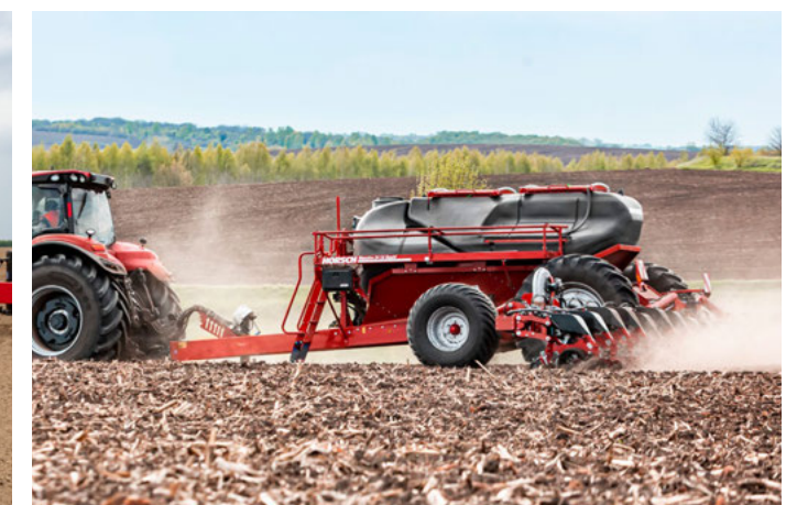
Перенесення ваги з насіннєвого бункера на насіннєву шину для високого тиску на сошник до 350 кг
