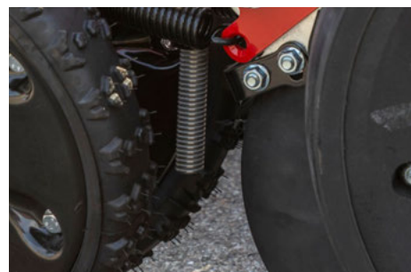
Внесення рідких добрив за уловлюючим роликом
