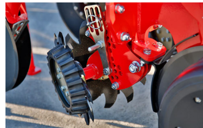
Опційні розгортачі борозни з регулюванням глибини у плаваючому положенні
