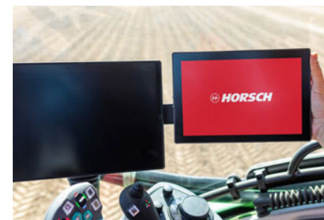
Завдяки регульованому кріпленню eosT10 ідеально впишеться в будь-яку кабіну
