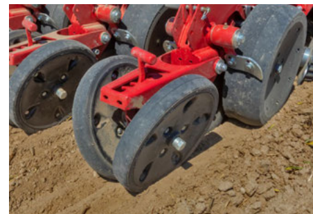
Широкі прикочувальні колеса з V-подібним розміщенням
