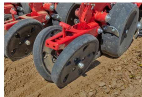
Широкі прикочувальні колеса з V-подібним розміщенням
