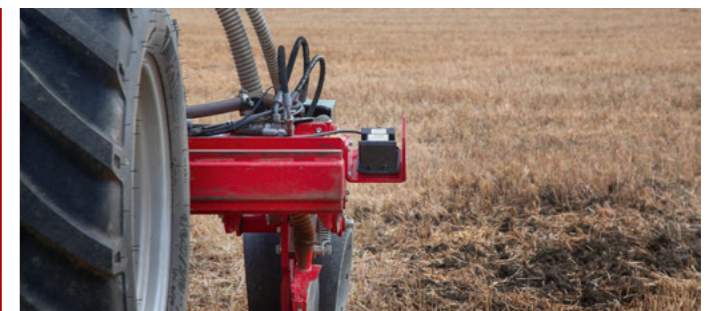
Один з додаткових сенсорів радарів системи ContourFarming
