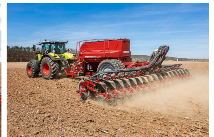
Maestro 18 SV з двосекційним бункером об'ємом 5400 л для добрив і 2200 л для насіння
