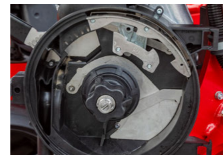
Універсальний відсікач, який не потребує налаштувань
