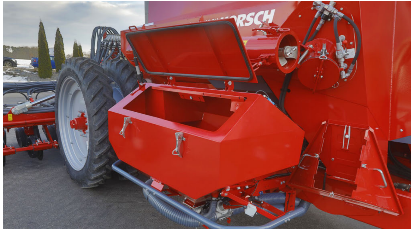
Бункер для внесення мікрогрануляту Для кращого доступу до машини й заправки бункер можна розкласти наперед
