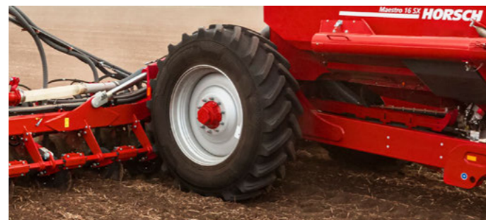
Хід коліс з широкопрофільними шинами налаштовується для проходу в міжрядді завдяки телескопічній осі
