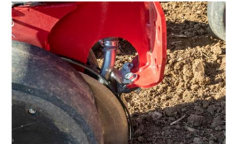
Пневматична подача матеріалу із подальшим внесенням у рядок
