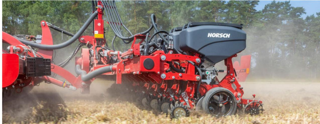
З навісним механізмом висівного бункера тиск на сошник досягає 350 кг
