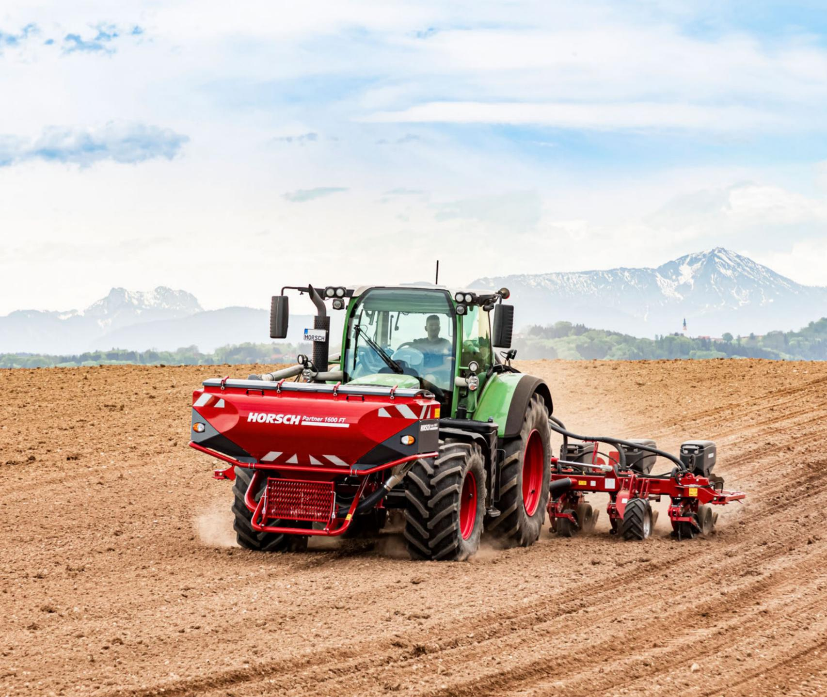
Висівна шина Maestro RV / RX може бути оснащена 6, 8 і 9 рядами з міжряддям 70 / 75 і 80 см. У 12-рядному варіанті ширина міжряддя становить 45 або 50 см. Нова система затискачів дає змогу швидко перебудувати машину з 12-рядної на 8-рядну. Можлива також 11-рядна конструкція з міжряддям 50/55 або 60 см.
