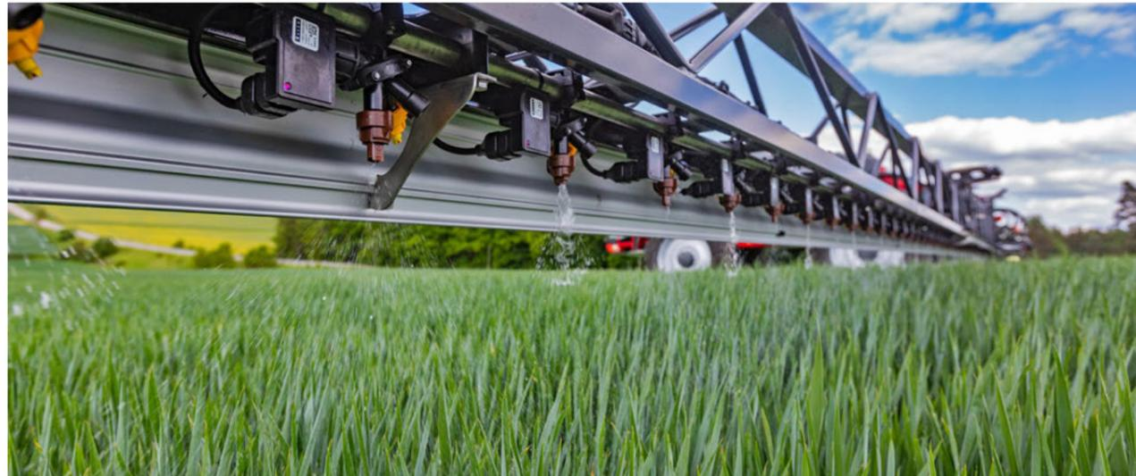
PrecisionSpray ist ein Pulsdüsenystem, das die Düsen mit einer Frequenz von 20 Hertz pulsierend auslöst. Damit lässt sich die Ausbringungsmenge stufenlos über den Duty Cycle anpassen – bei konstantem Druck und Tropfengröße mit variabler Geschwindigkeit und unter Beibehaltung der Spritzzeigenschaften. Dadurch können größere Düsen verwendet werden, die unempfindlicher gegenüber Verstopfungen sind, und die Anzahl der notwendigen Düsenkaliber wird
