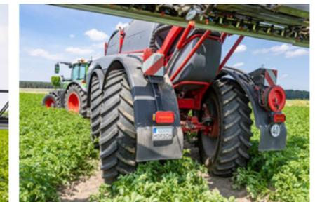
Aktive Lenkung beider Achsen in Maschinensoftware integriert
