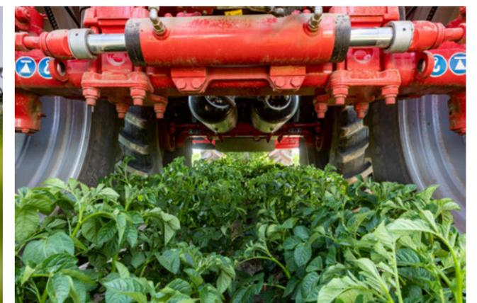
Hohe Bodenfreiheit mit Bereifung bis Ø 2,19 m
