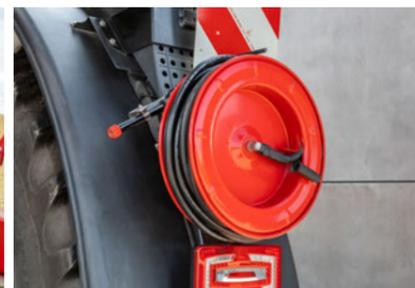
Schlauchtrommel zur Außenreinigung
