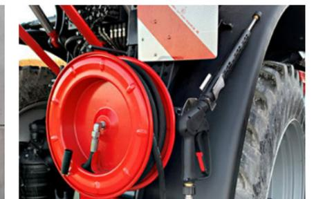
Hydraulisch betriebener Hochdruckreiniger
