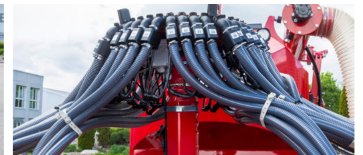
Die Säschiene kann individuell mit Fahrgassenklappen ausgestattet werden
