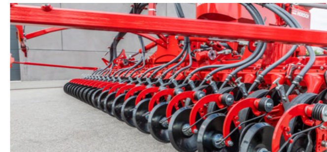
Stabil gebautes SingleDisc Säschar für Mulch- und Direktsaat
