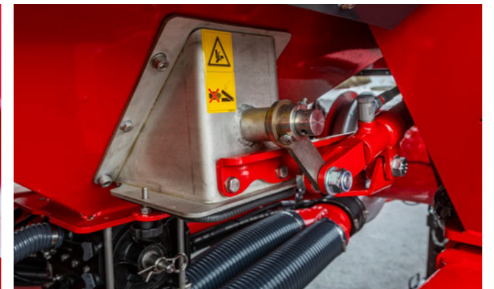
Rührwelle Düngertank außen
