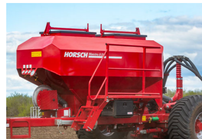
Doppeltanksystem mit 3 500 l Volumen
