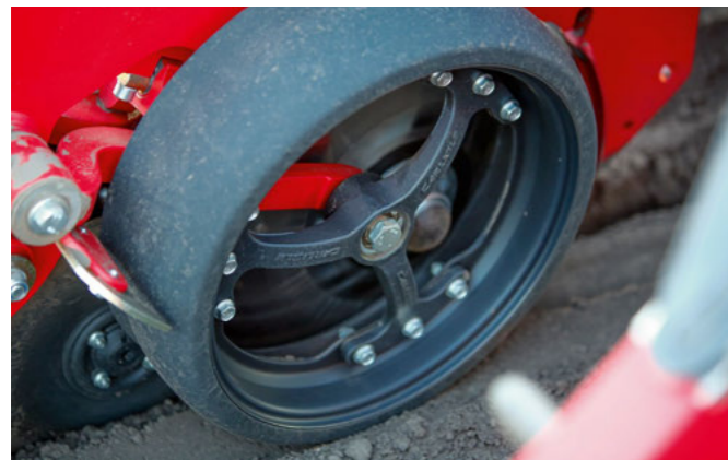
Speichertiefenführungsrad: bessere Selbstreinigung, daher ideal bei Schwarzerdeböden
