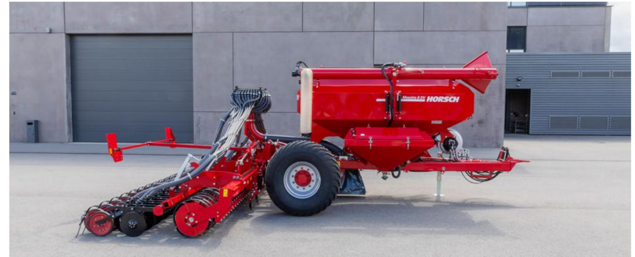
Die 4-Punkt Säschiene TD CoulterBar kann an alle Maestro DV mit Doppeldrucktank angebaut werden. Sie kann im abgesetzten Säverfahren für alle Arten von Getreide zur Drillsaat eingesetzt werden. Der vorlaufende RollFlex Packer sorgt für eine gute Rückverfestigung und ausreichend Feinerde. Durch das Doppeltanksystem der Maestro DV ist eine Grain & Fertiliser Applikation über die Turbo-Disc Schare möglich.
