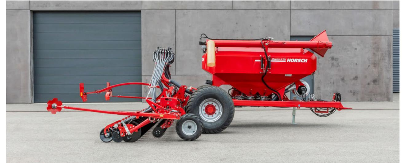
Die Avatar SL 4-Punkt Säschiene mit 6 m Arbeitsbreite kann an alle Maestro DV mit Doppeldrucktank angebaut werden. Das bewährte SingleDisc Säschar ist besonders auch für schwere, steinige und harte Bedingungen in Mulch- oder Direktsaat geeignet. Durch das Doppeltanksystem der Maestro DV ist eine Grain & Fertiliser Applikation über die SingleDisc Schare möglich.
