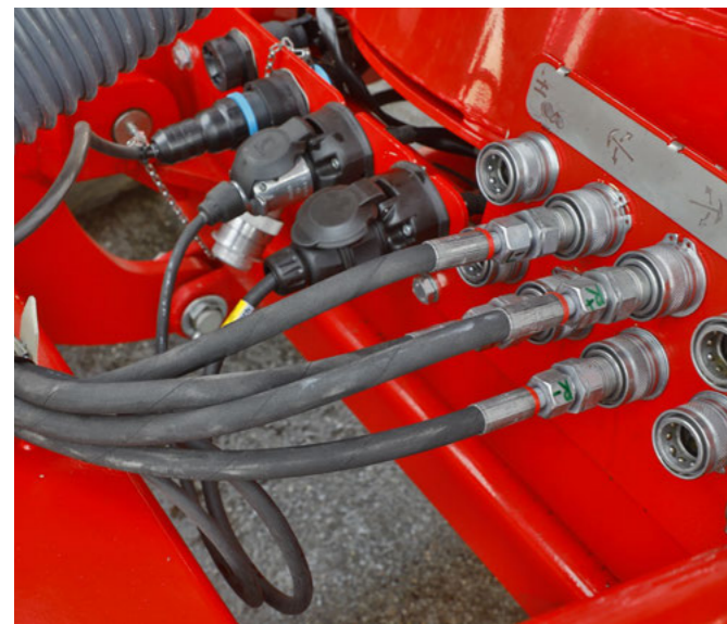
Aufgeräumte Trennstelle für Hydraulik und Pneumatik
