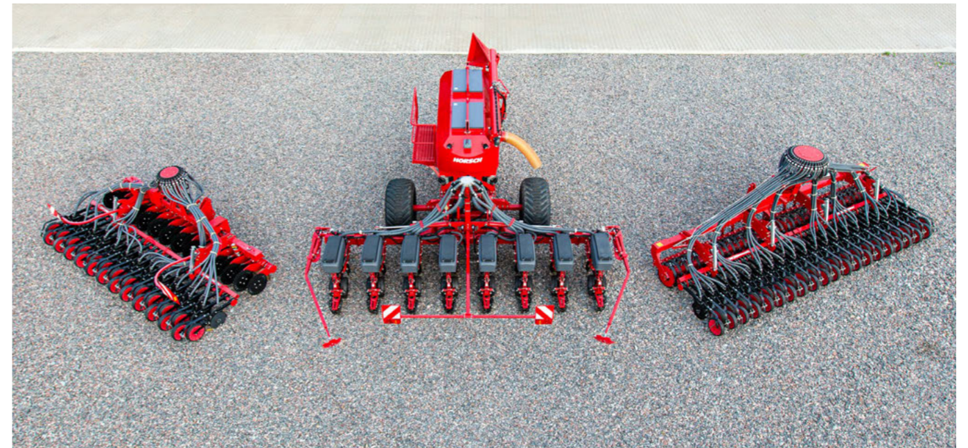
Maestro DV mit Trennstelle für einen flexiblen Einsatz
