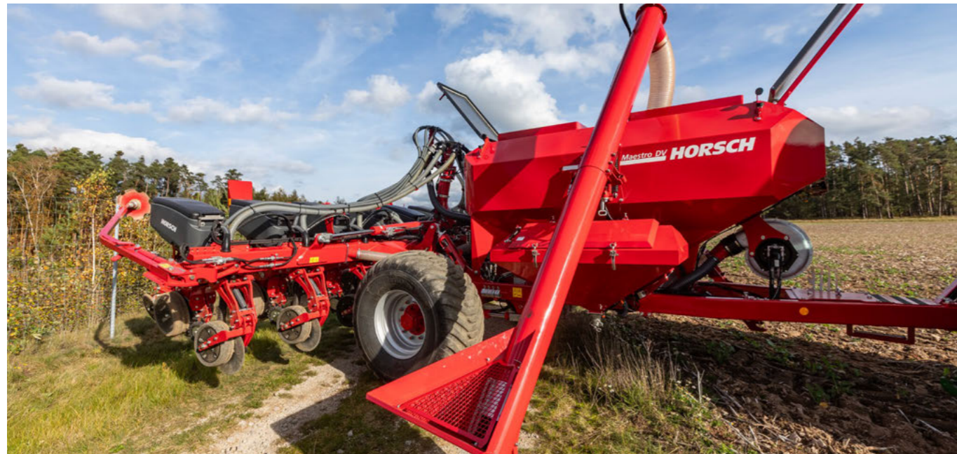
Die Befüllschnecke kann für beide Düngertanks der Maestro DV genutzt werden
