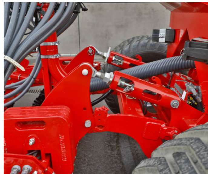
4-Punkt Trennstelle an der DV
