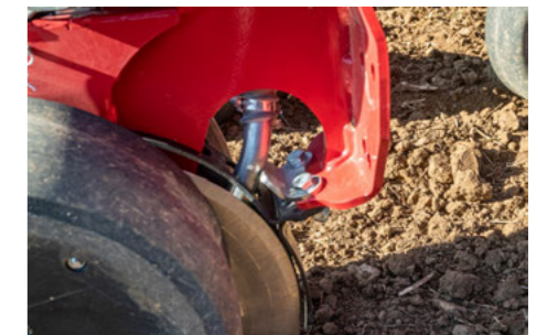
Pneumatische Applikation IN die Reihe
