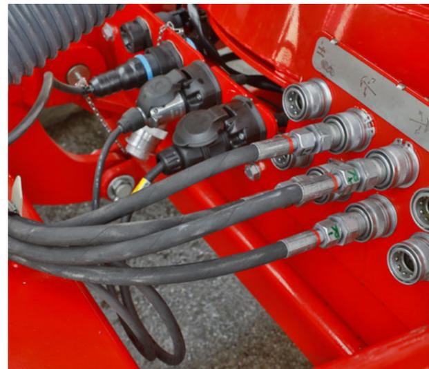
Aufgeräumte Trennstelle für Hydraulik und Pneumatik
