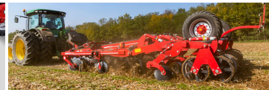
Интенсивная обработка почвы посредством дисков и стоек
