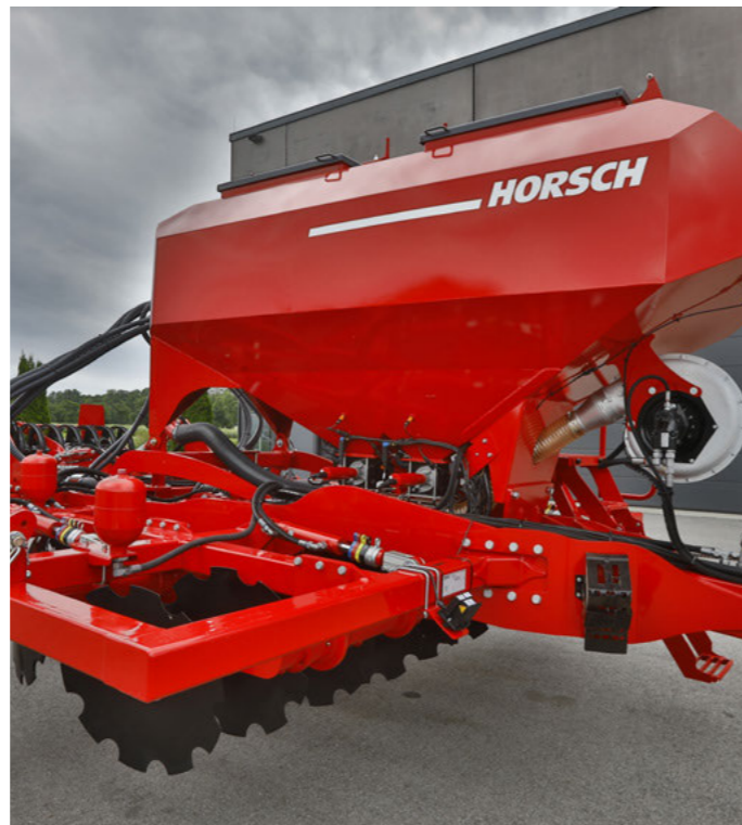
FertiProf с бункером на 2 800 л для адресного внесения удобрений за один проход
