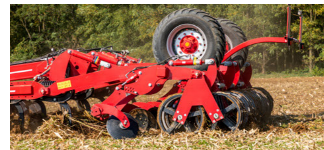
Большой выбор катков благодаря револьверному шасси
