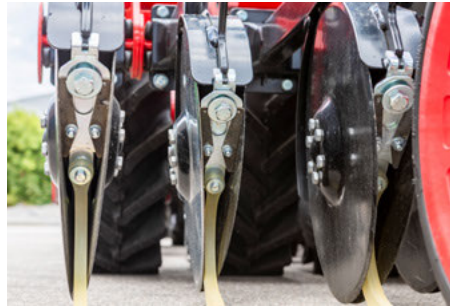
Подвижный чистик гарантирует эффективную самоочистку в условиях повышенной влажности
