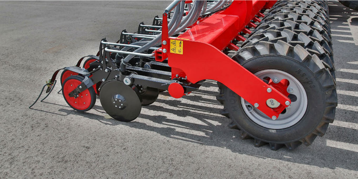
Сошник PowerDisc — двухдисковый сошник с параллелограммной подвеской
