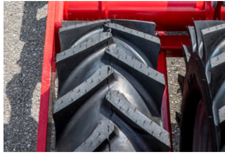
Прямой профиль шин способствует более эффективному прикатыванию почвы по краям
