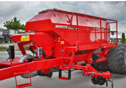
Приспособление для простого и безопасного внесения микрогранулята (опция)
