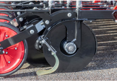
Расположение трубки сошника перед демпфером и наличие подвижного внутреннего чистика предотвращают засорение сошников при посеве в условиях повышенной влажности
