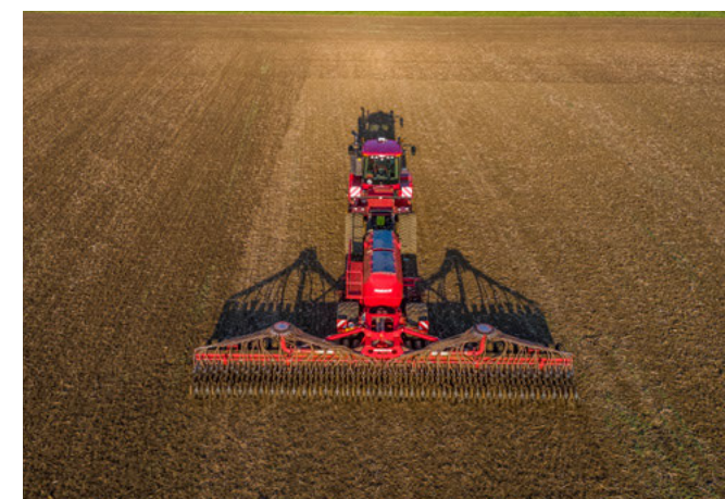
Точное соблюдение заданной глубины заделки по всей рабочей ширине за счет перераспределения веса бункера на крылья сошников с помощью гидравлики
