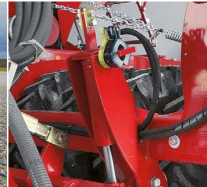
Простая настройка глубины заделки при помощи алюминиевых упоров
