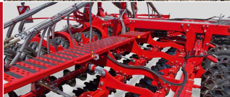
Защитные сходы над дисковой бороной для удобного доступа ко всем узлам машины
