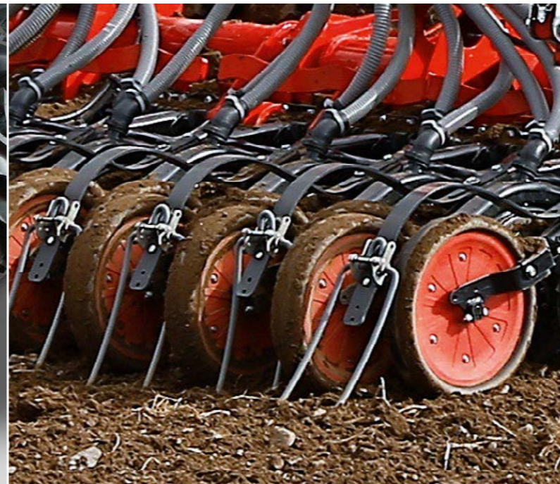
Прикатывающие ролики и зубья пружинной бороны
