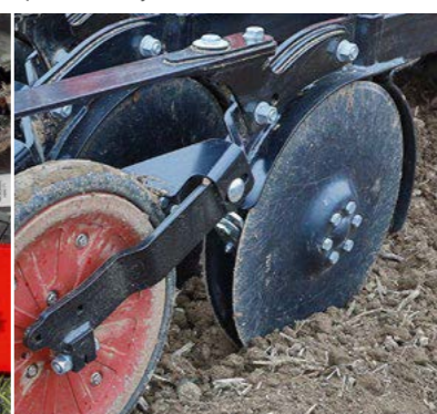
Двухдисковый сошник Гладкие диски с расположенными внутри необслуживаемыми подшипниками
