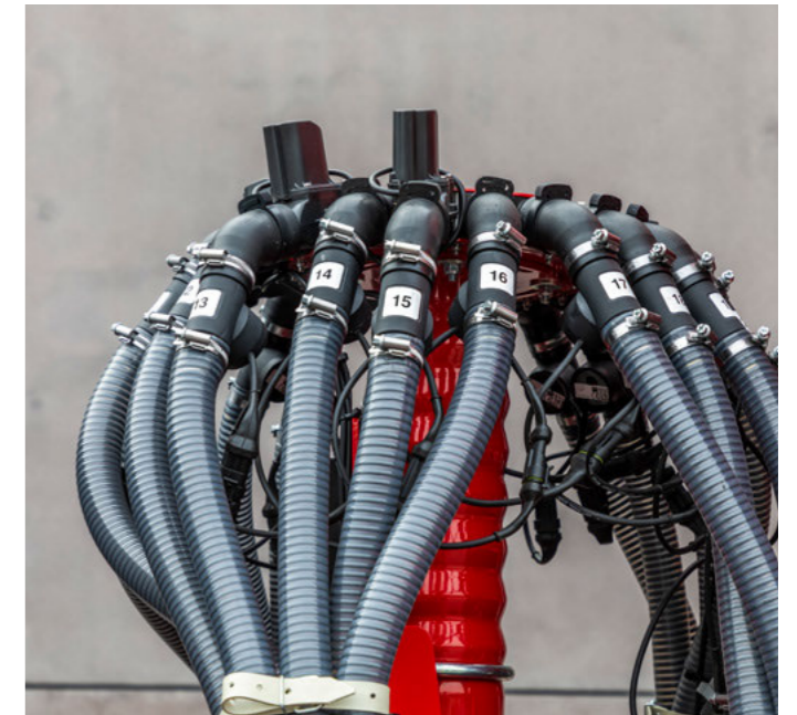
Контроль расхода удобрений и семян — непрерывный мониторинг состояния шлангов
