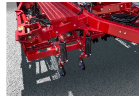
Подпружиненные стойки используются для рыхления уплотненной почвы в колеях от колес трактора
