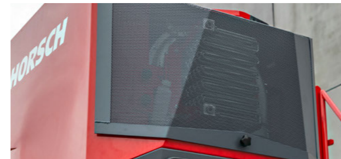
Масляный радиатор на гидравлическом компрессоре для нагрева воздушного потока в пневматической системе
