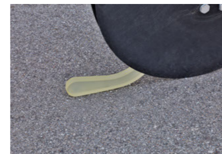
Семяукладчик HORSCH обеспечивает точную фиксацию семян.
