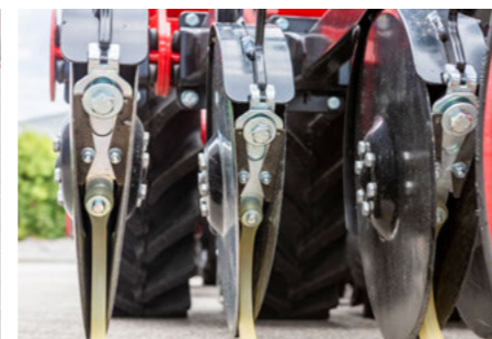
Подвижный чистик гарантирует эффективную самоочистку в условиях повышенной влажности
