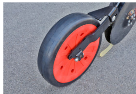
Прикатывающий ролик шириной 7 см идеально подходит для легких почв
