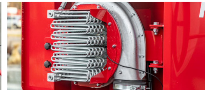
Снижает температуру масла в системе и уменьшает нагрузку на масляный радиатор трактора
