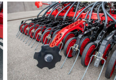
Агрессивность предвсходового маркера регулируется с помощью ограничителя глубины
