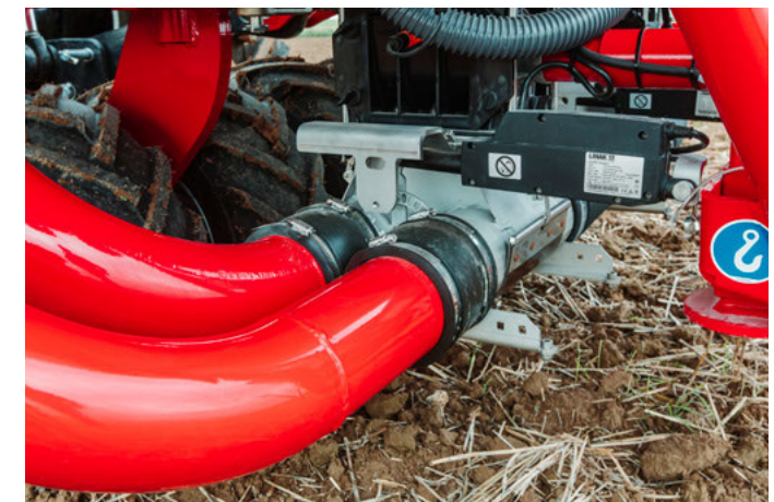
Электрическое отключение половины ширины захвата: простое включение и выключение нажатием кнопки на терминале
