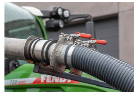
Простое подключение пневмошлангов без специнструмента
