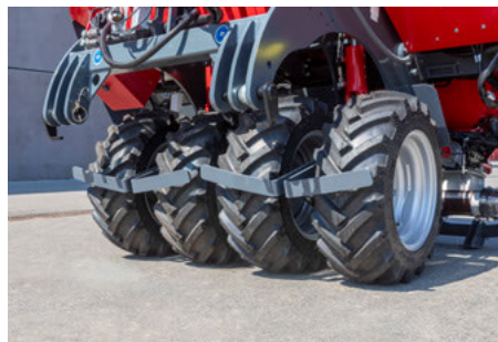
Межосевой каток с пассивным управлением и гидравлическим подъемом
