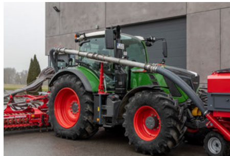
Горизонтальное положение труб гарантирует минимальное ограничение обзора
