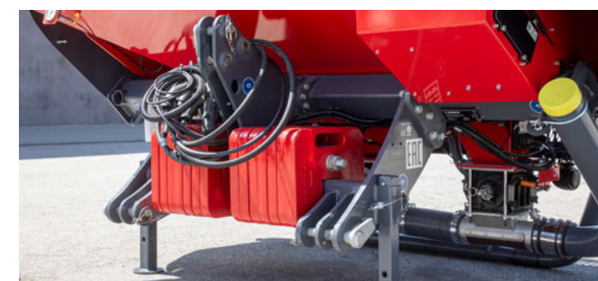
Оптимальная балансировка благодаря дополнительному балласту
