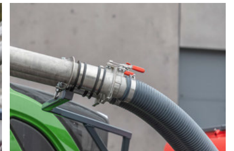
Быстроразъемные соединения позволяют легко и быстро соединять фронтальный бункер с трактором и прицепным оборудованием
