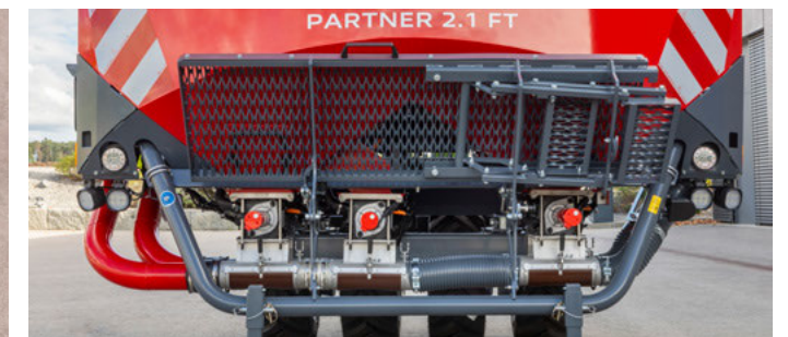
Трехсекционные бункеры Partner 2.1 и 2.5 FT: три независимых дозатора для трех компонентов
