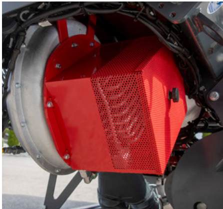
Масляный радиатор для подогрева всасываемого воздуха (опция)
