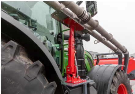
Устойчивый и надежный опорный кронштейн для пневмотруб бункера Partner FT
