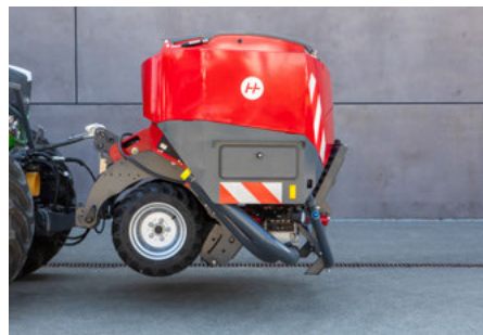
Межосевой каток с гидравлическим подъемным механизмом в транспортном положении на дороге
