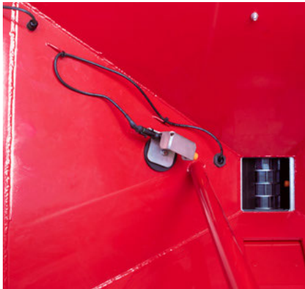
2 датчика уровня заполнения: один регулируемый по высоте в бункере и один непосредственно на дозаторе
