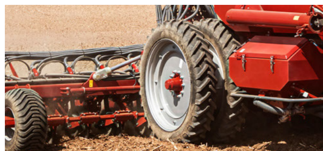
Спаренные шины 300/95 R 46 для моделей 18 и 24.45/50 SV/SX
