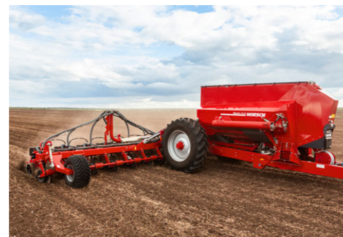
Благодаря телескопической оси крупногабаритные шины движутся между рядами
