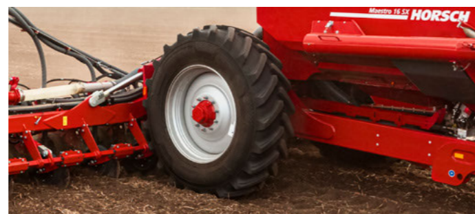
Благодаря телескопической оси крупногабаритные шины движутся между рядами
