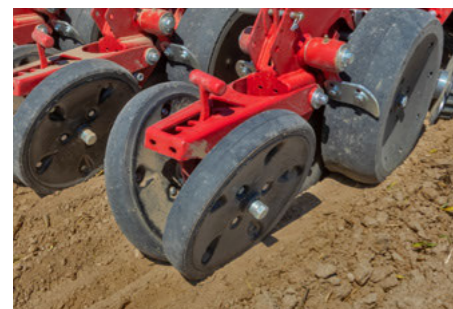
Широкие прикатывающие ролики с V-образным расположением
