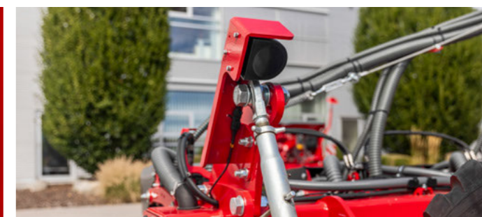
Один из дополнительных радарных датчиков для ContourFarming
