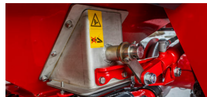
Мешалка бункера для удобрений (вид снаружи)
