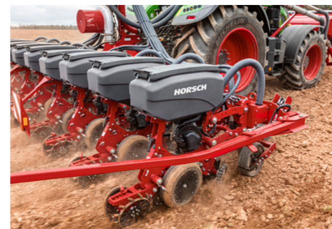
Гидравлическая регулировка давления на сошники для безупречной заделки семян
