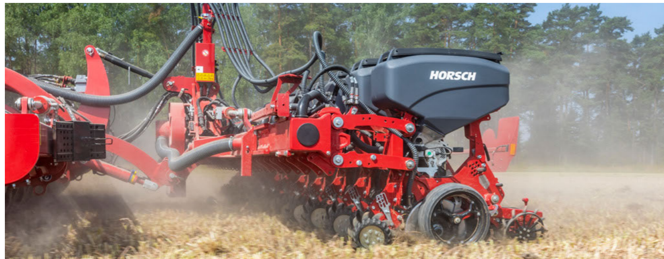
С бункером для семян возможно увеличение давления до 350 кг на сошник
