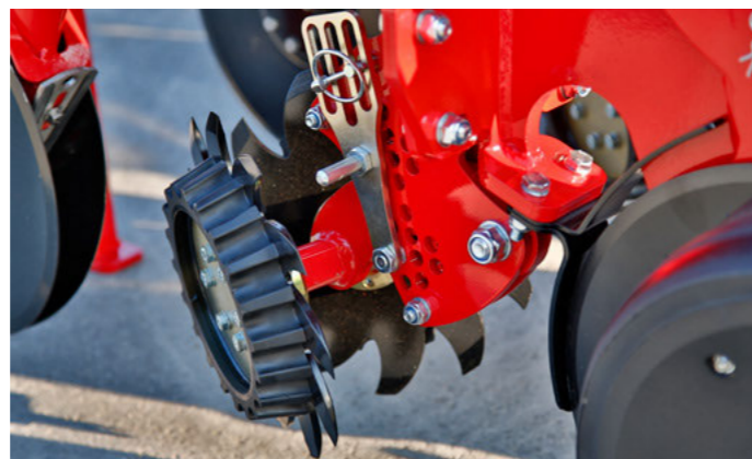
Оptionальные бороздоочистители с регулировкой глубины в плавающем положении
