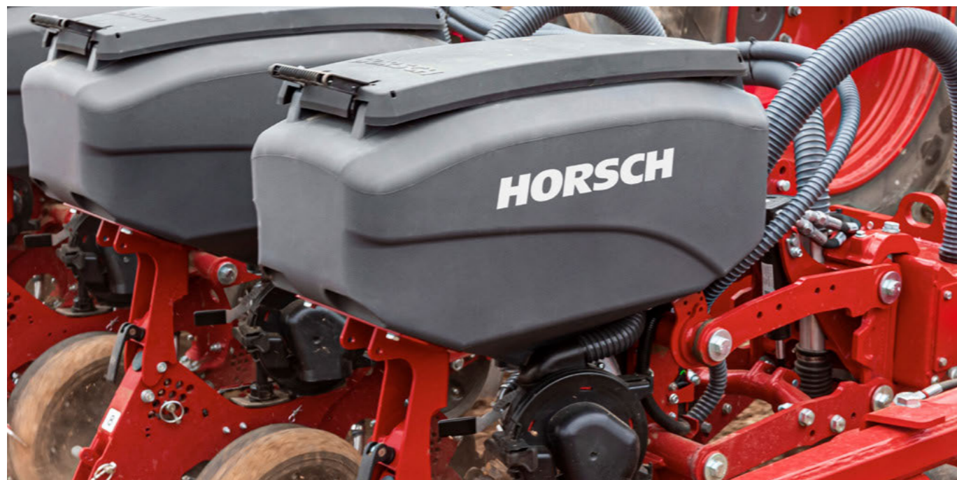
Семенные ящики объемом 70 л на высевающих секциях
