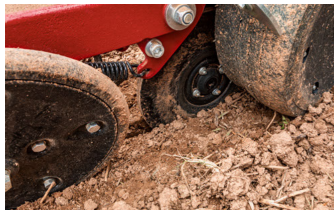
Улавливающий ролик крайне важен для обеспечения хорошего контакта семян с почвой
