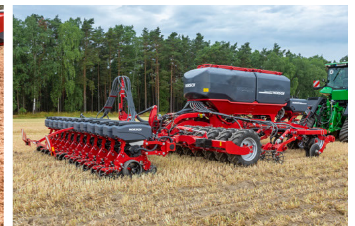
Технология StripTill: Maestro RV и Focus TD с 3-точечной навеской
