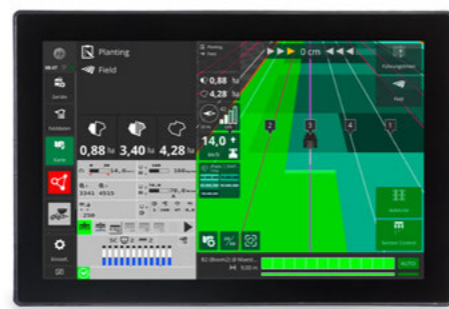
Машины для точного высева в комбинации HORSCH AutoLine позволяют на основе GPS-данных гибко прокладывать технологическую колею независимо от направления движения
