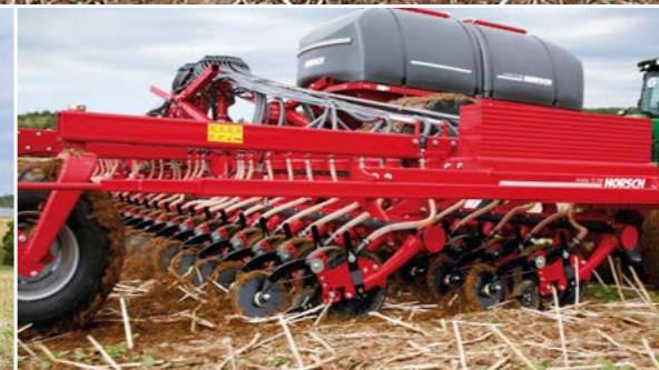
2-рядная рама с высокой проходимостью
