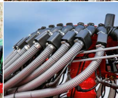
Надежные датчики контроля прохождения туко-/семяпроводов
