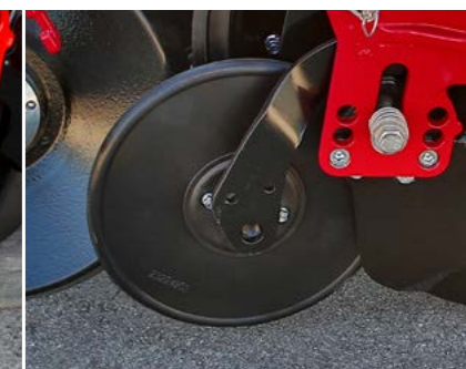
Прикатывающий ролик обеспечивает плотный контакт семян с почвой
