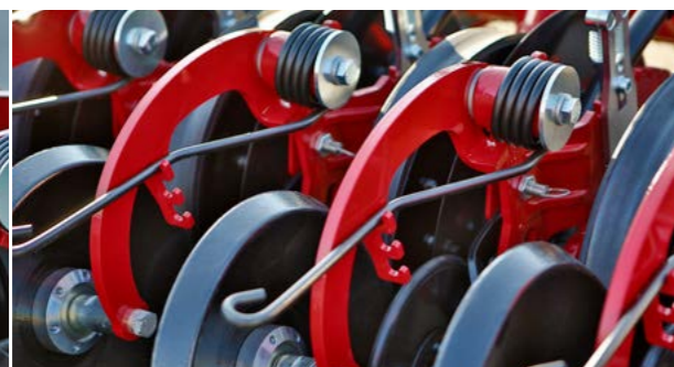
Давление прижима прикатывающих роликов обеспечивается пружинным механизмом и регулируется без специнструмента.
