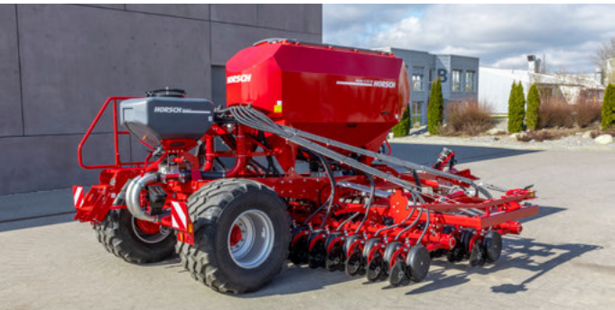
Двухсекционный бункер объемом 5 000 л и MiniDrill с баком на 400 л
