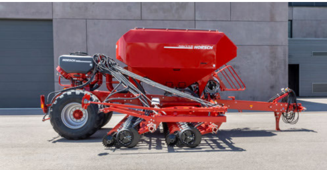
Двухсекционный бункер объемом 5 000 л
