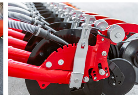
Точная регулировка глубины посева без специнструмента
