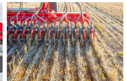
Минимальное нарушение сложения почвы благодаря сошнику SingleDisc
