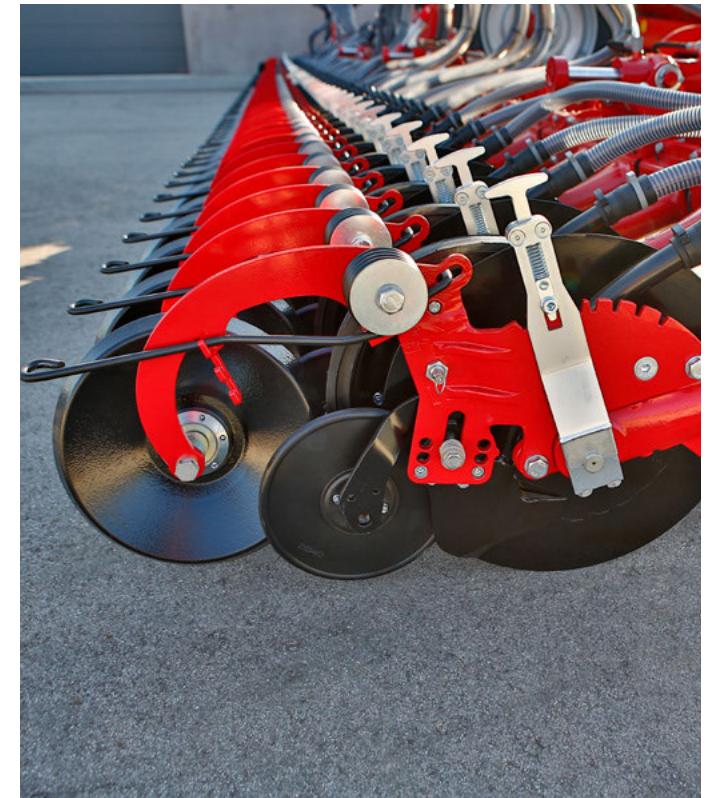
Превосходная фиксация семян благодаря прорезиненному улавливающему ролику
