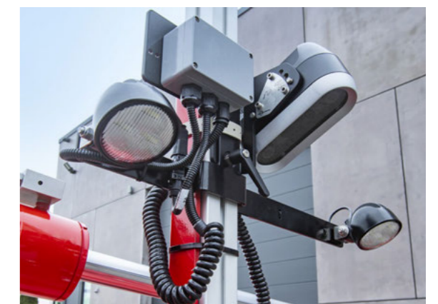
Guidage par caméra CultiCam avec kit d'éclairage optionnel pour le travail à l'aube ou dans l'obscurité
