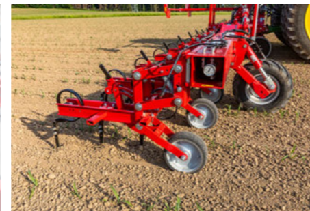
Châssis de conception robuste de section rectangulaire avec serrage intérieur
