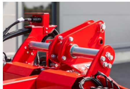
Châssis mobile largement dimensionné avec 450 mm de débattement
