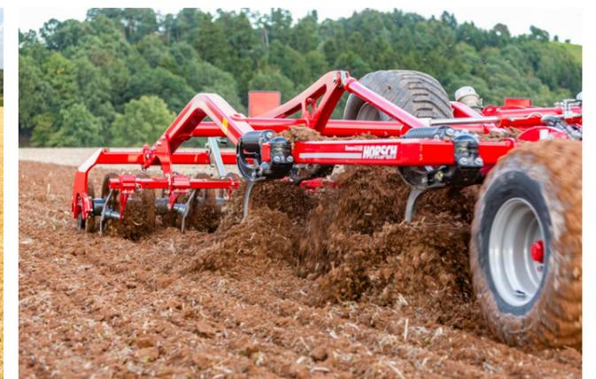
Disques de nivellement pour un lit de semences parfaitement uniforme
