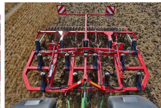
Répartition uniforme des dents pour optimiser le flux de terre
