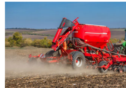
Remplissage facile grâce à la vis de remplissage hydraulique
