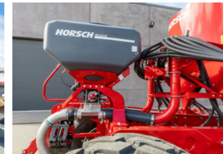
Le MiniDrill de 400 l utilisé pour la semence de colza permet de réserver les autres trémies pour l'engrais minéral.
