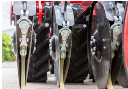
Le racleur mobile garantit un auto-nettoyage en conditions humides
