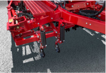
Les dents efface-traces à sécurité ressort permettent d'ameublir les zones compactées dans les traces du tracteur
