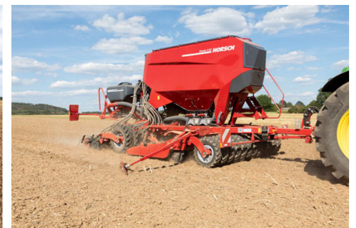
Traceurs de pré-levée en option pour un raccordement parfait lors des prochaines interventions
