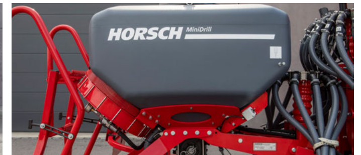
Pour ces différentes variantes, le MiniDrill dispose de sa propre soufflerie et de son propre système pneumatique et d'un horizon de semis complémentaire
