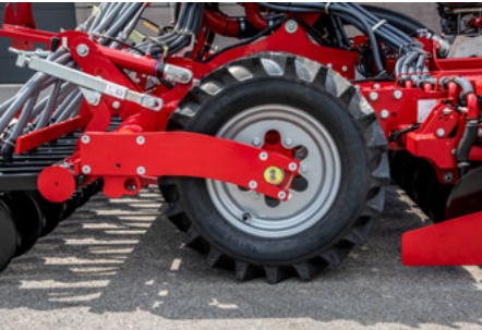
Faible demande de puissance grâce aux pneus de grand diamètre dépourvus de décrotteurs
