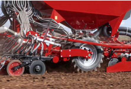
Rappui efficace sous l’horizon de semis pour une remontée de l’humidité par capillarité
