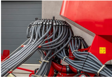
Tête de distribution PPF en option pour une accessibilité optimale
