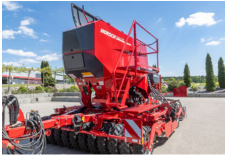
Réservoir sous pression avec accès latéral
