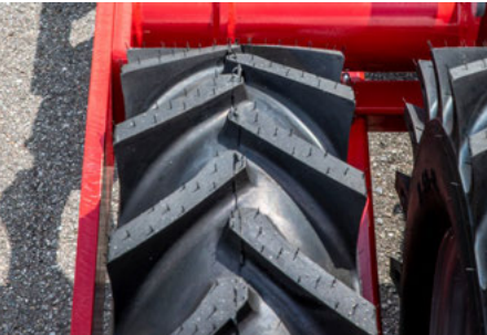
Le profil agraire de la roue accroît le rappui en bordure
