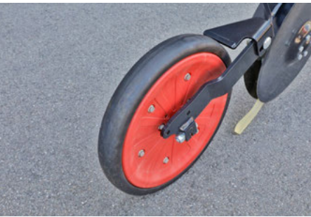
Roulette de rappuie 5 cm de large – idéale pour les sols moyens à lourds
