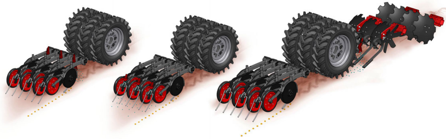
MiniDrill variante 9 : application via les éclateurs sur la Crossbar en option. Idéal pour le semis de plantes compagnes, car celles-ci sont à nouveau rappuyées par le packer à pneus.
