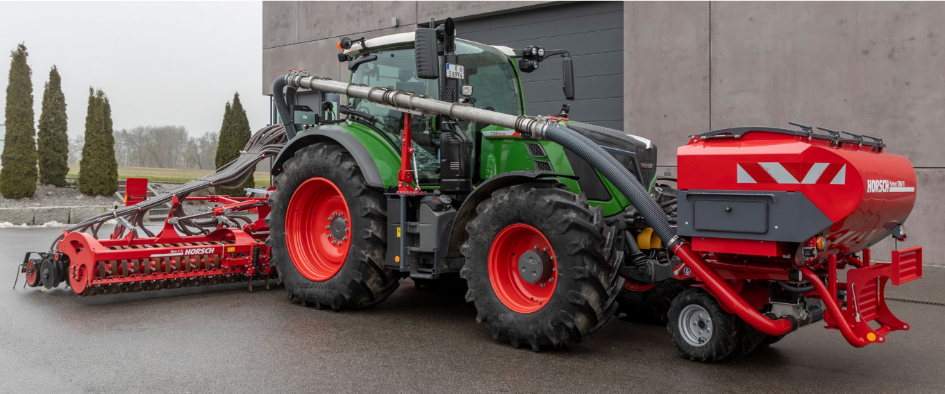
Le montage horizontal du système pneumatique garantit une visibilité maximale.
