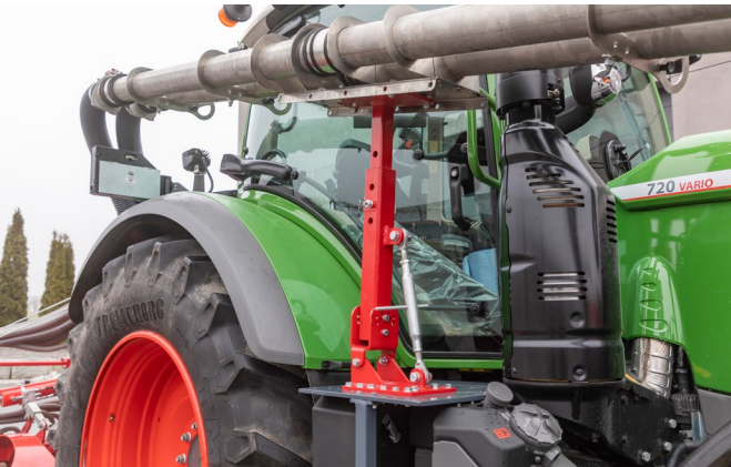
Kit de support pour le système pneumatique
