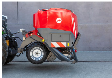
Packer à pneus avec relevage hydraulique en position de transport
