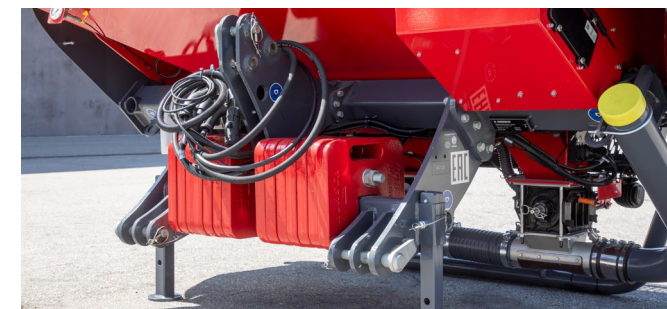
Equilibrage parfait grâce aux masses additionnelles
