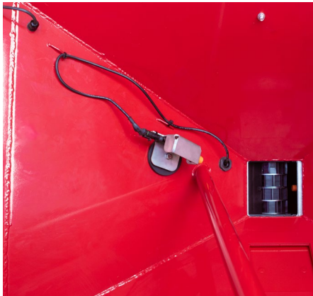
2 capteurs de niveau – un réglable en hauteur dans la cuve et un directement sur le doseur
