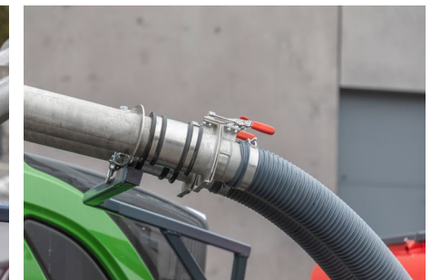
Les raccords rapides facilitent l'attelage et le dételage entre la cuve avant, le support du tracteur et l'outil porté
