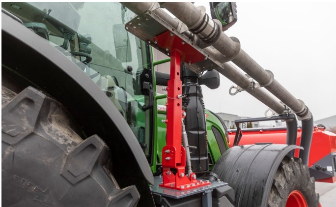
Maintien stable et fiable du système pneumatique Partner FT grâce au bras de support
