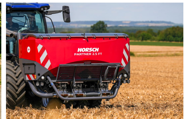
Partner 2.5 FT avec packer à pneus escamotable hydrauliquement
