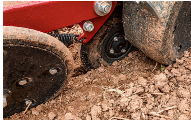
La roulette de plombage est décisive pour un bon contact terre / graine
