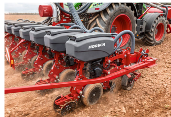
Adaptation hydraulique de la pression sur les éléments pour un placement sans compromis
