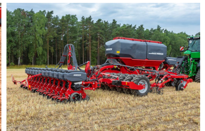
Utilisation du Maestro RV combiné avec le Focus TD 3 points pour le semis StripTill
