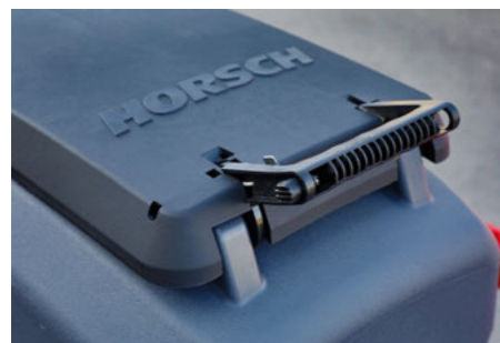
Fermeture de la cuve sur le rang
