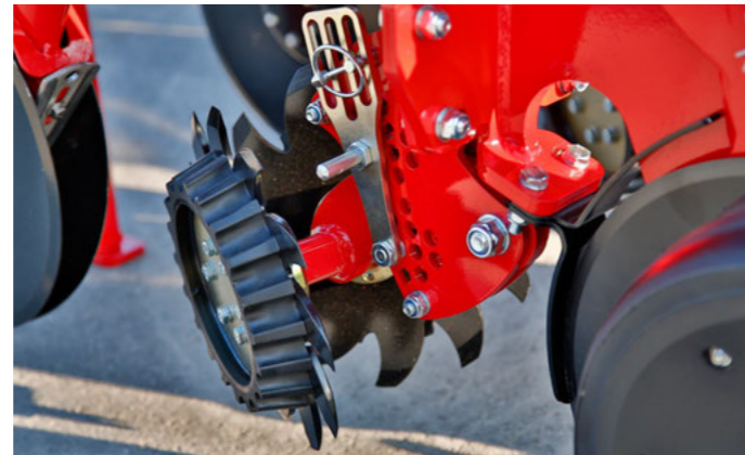
Étoile chasse résidus en option, en position flottante avec contrôle de terrage
