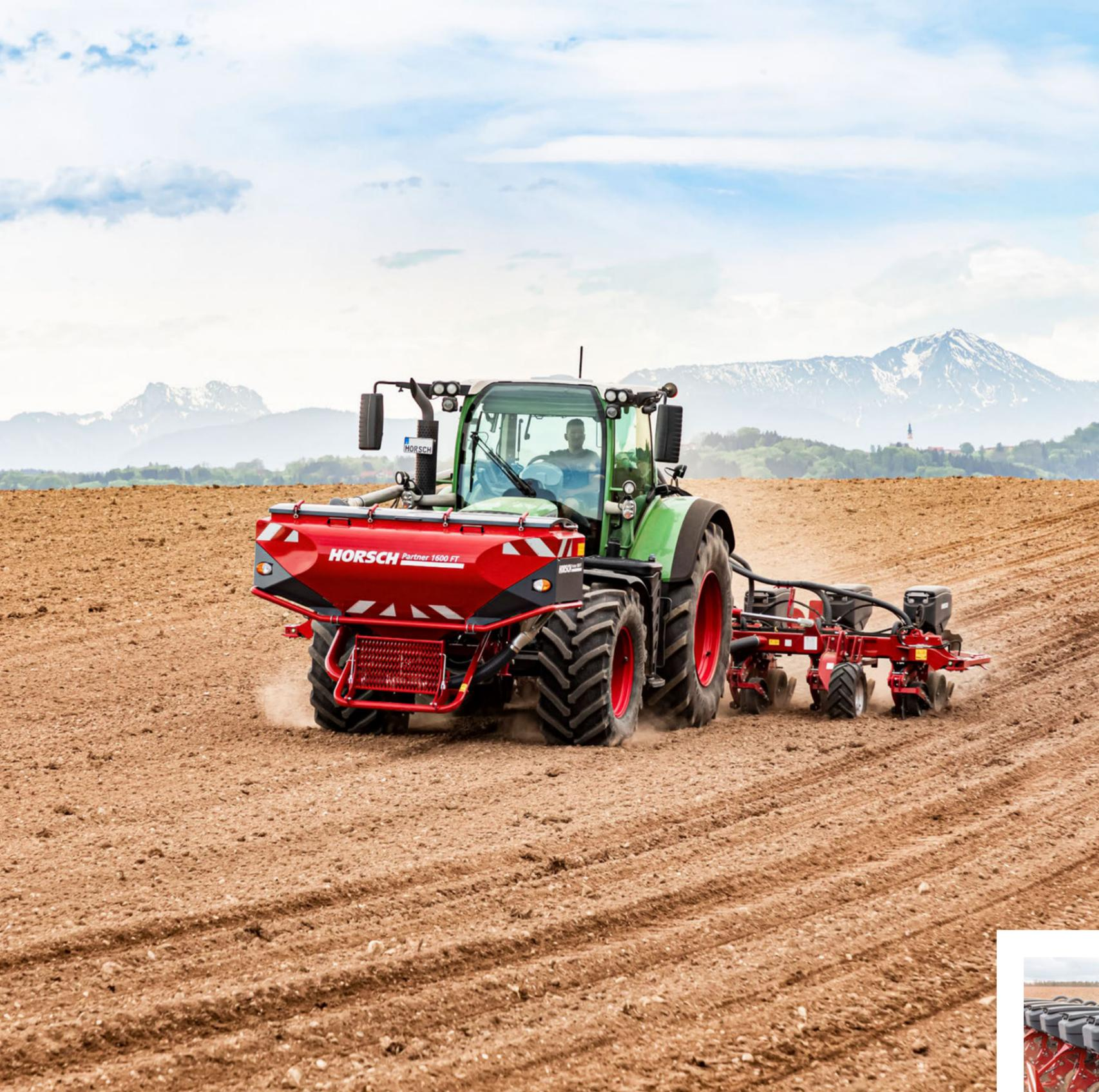
La rampe de semis des Maestro RV / RX peut être équipée en 6, 8 ou 9 rangs avec des interrangs de 70 / 75 ou 80 cm. En cas d'utilisation avec 12 rangées, des interrangs de 45 et 50 cm sont disponibles. Le nouveau profil de serrage des éléments permet une conversion facile de 12 à 8 rangées. Il est également possible d'avoir 11 rangs avec des interrangs de 50/55 et 60 cm.
