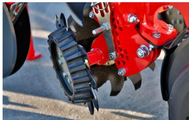
Etoile chasse-résidus en option, en position flottante avec contrôle de terrage
