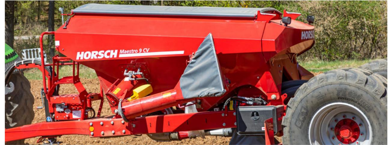
Vis de remplissage hydraulique escamotée
