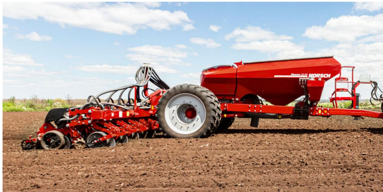
Trémie à engrais et semences centralisée
