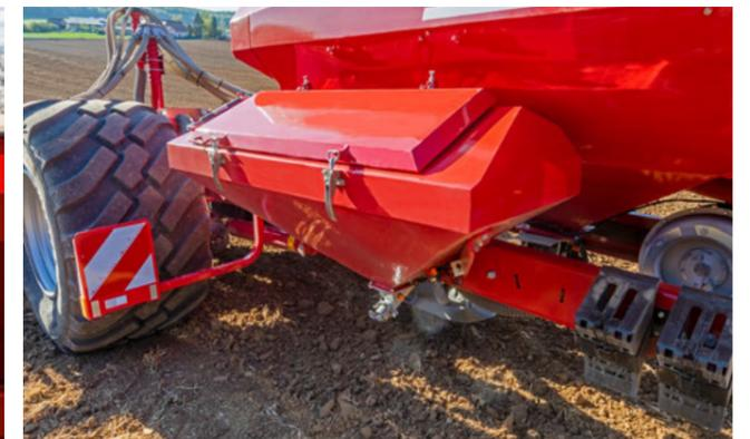
Trémie microgranulateur centralisée de 300 l
