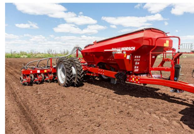
Trémie à engrais de 3 000 litres et trémie pour semences centralisée avec une capacité de 800 litres
