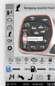
La fonction des touches librement attribuables sur le joystick de l'ErgoControl peut être facilement sélectionnée sur l'écran du véhicule.
