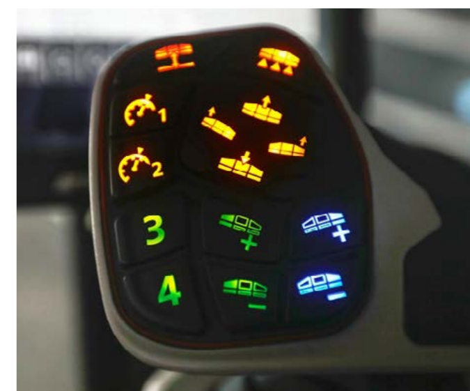
Joystick ErgoControl unique en son genre avec rétroéclairage
