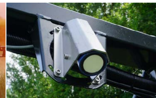
Extension avec une autre paire de capteurs à ultrasons
