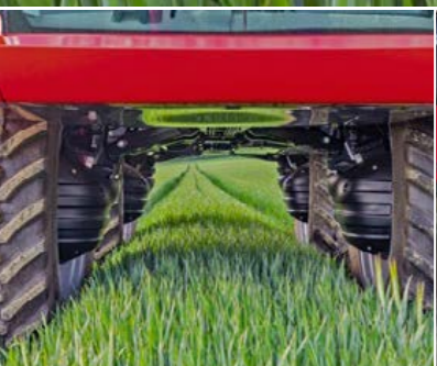
Revêtement du carénage et des moteurs-roues pour protéger les cultures
