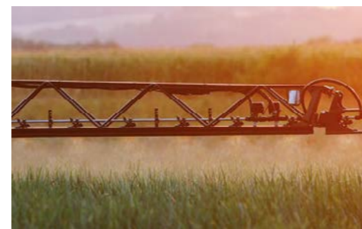
BoomControl – guidage automatique en hauteur par capteurs à ultrasons
