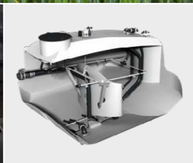
Cuve principale en inox de 8 000 litres à rinçage facile avec parois anti-rouli intégrées
