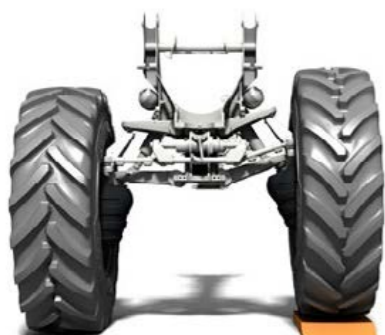
Correction automatique de niveau : suspension hydropneumatique indépendante des roues et réglage actif du niveau
