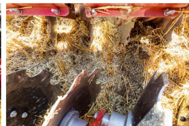
Montage des disques par paire pour un dégagement maximal
