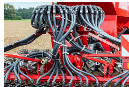
Tête de distribution RowControl – version deux têtes de répartition pouvant équiper le Pronto 6 et 7 DC
