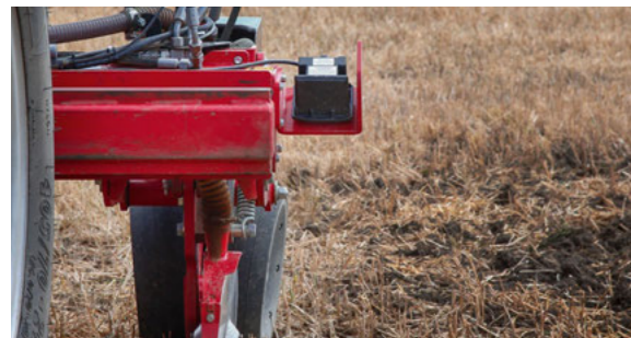
L'un des capteurs radars supplémentaires pour le ContourFarming
