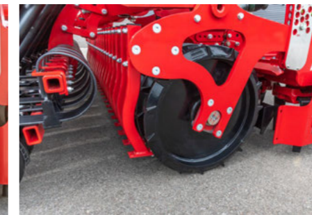
Rouleau trapèze 60 cm de diamètre
