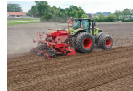
La trémie double cuve G&F permet de doser séparément deux produits et de les déposer sur un seul et même horizon.
