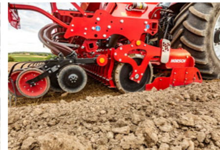
Changement de la profondeur de semis sans outils
