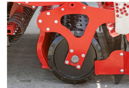
Rouleau trapèze 50 cm de diamètre
