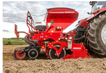
En fourrière, la rampe de semis peut être relevée hydrauliquement.
