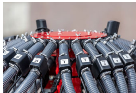
Système pneumatique spécifique pour les céréales vêtues
