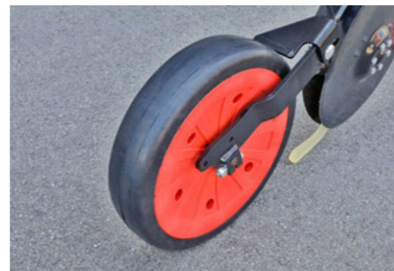
Roulette de rappui 7 cm de large – idéale pour les sols légers
