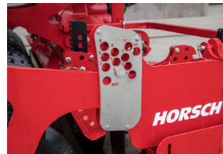
Réglage de la profondeur de travail sans outils via des broches et repères gradués
