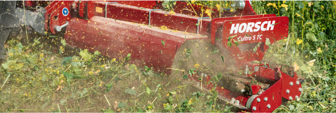
Rouleau double couteaux pour un émiettement idéal
