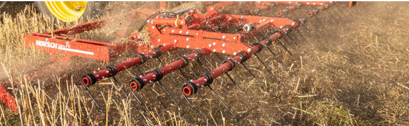
Triple rangée de herse lourde en option pour la production de terre fine et la répartition de la matière organique
