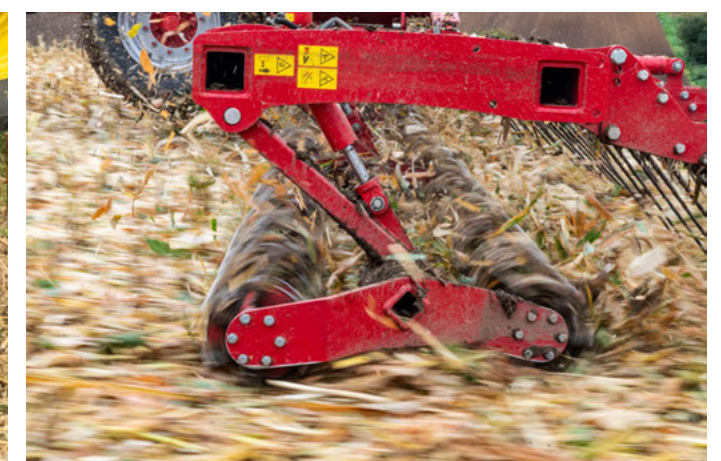
Double rouleau couteaux avec une longueur de coupe théorique de 14 cm
