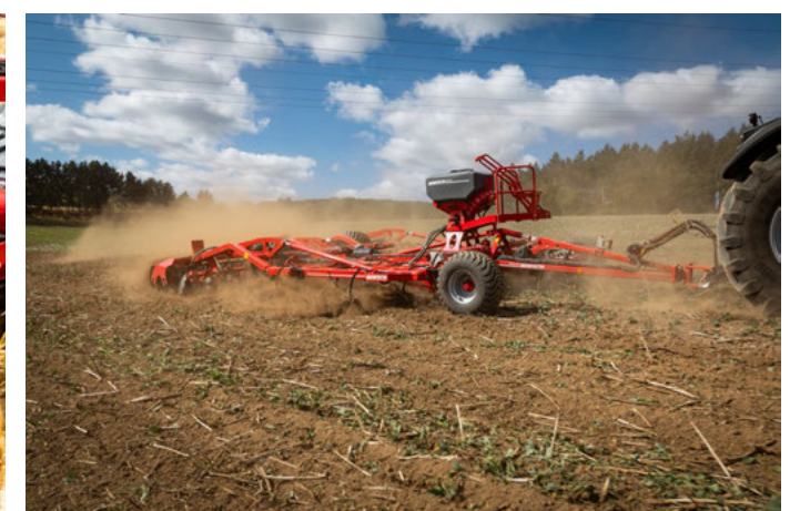
Les pattes d'oie de 20 cm de largeur permettent un scalpage sur toute la surface.
